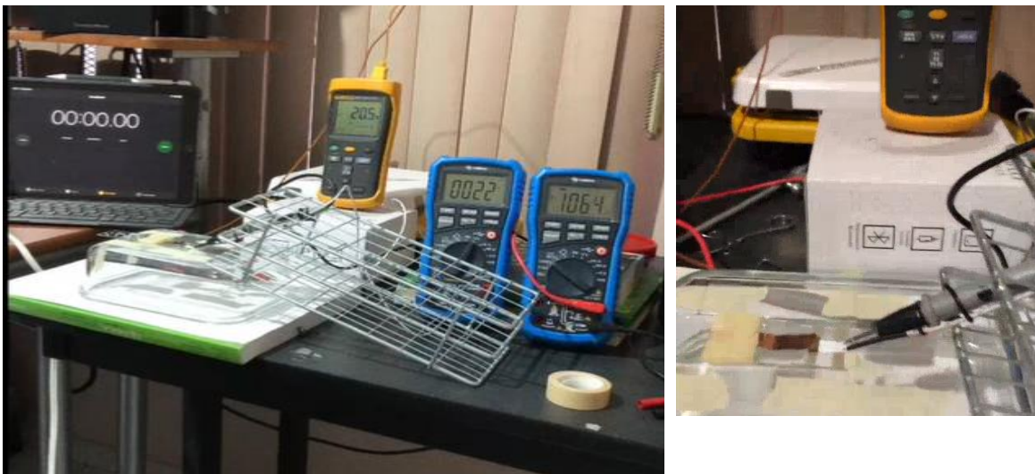
Figura 2.5. Montaje experimental para la medición empleando el método punta caliente.
