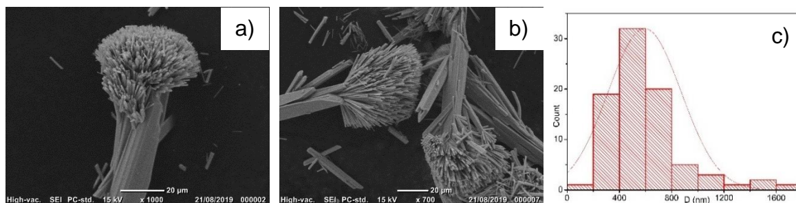
Figura 3.12 (a-c) Imagen SEM de Sb_2S_3 empleando SbKT, 25% v/v, 24 h e histograma de distribución de tamaño.
