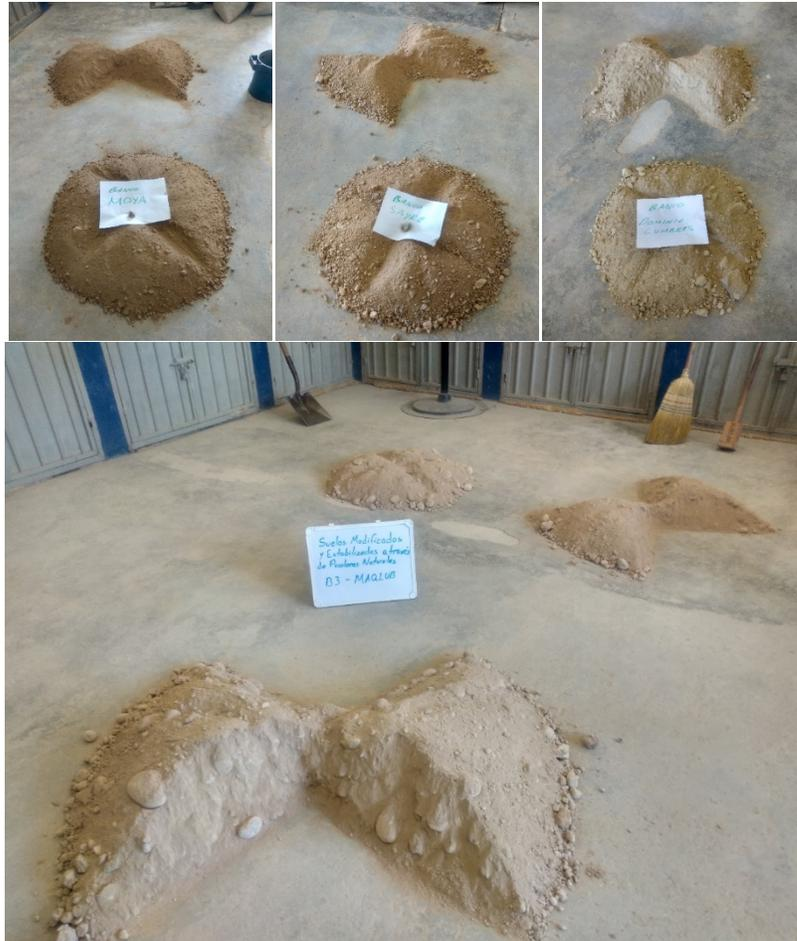
Figura 17 Cuarteo y reducción de las muestras para obtener fracciones representativas
