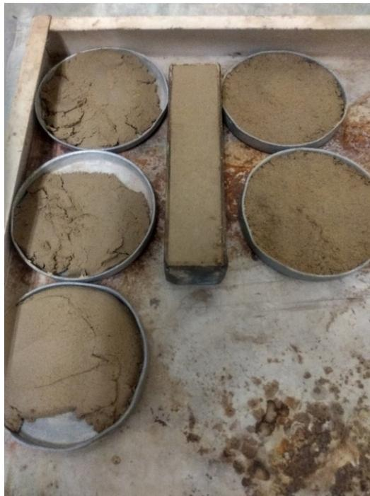
*Figura 26 Muestras de limite líquido, limite plástico y barra de contracción B4 Moya*
