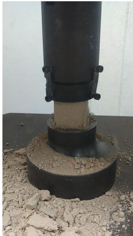
Figura 33 Ensayo a compresión de cubos 5 x 5 cm
