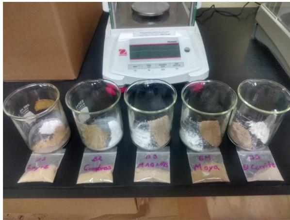
Figura 28 Mezclas de 10g de material con 1g de cera inerte
