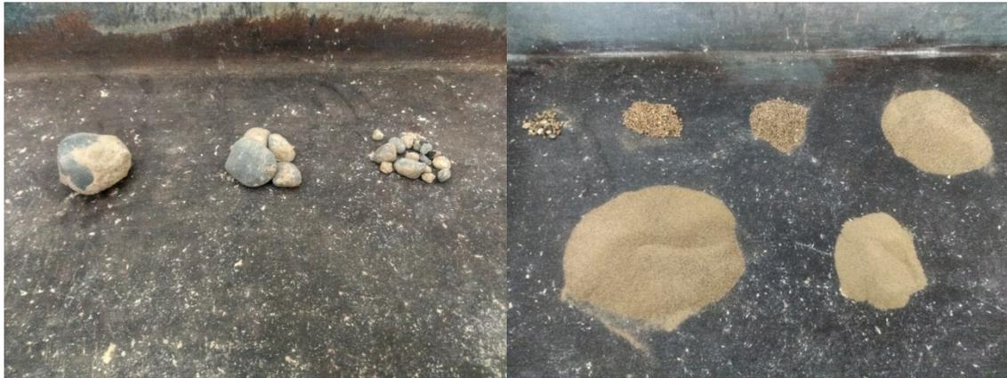
Figura 21 Granulometría parte gruesa (Izq.) y parte fina (Dcha.) B4 Moya
