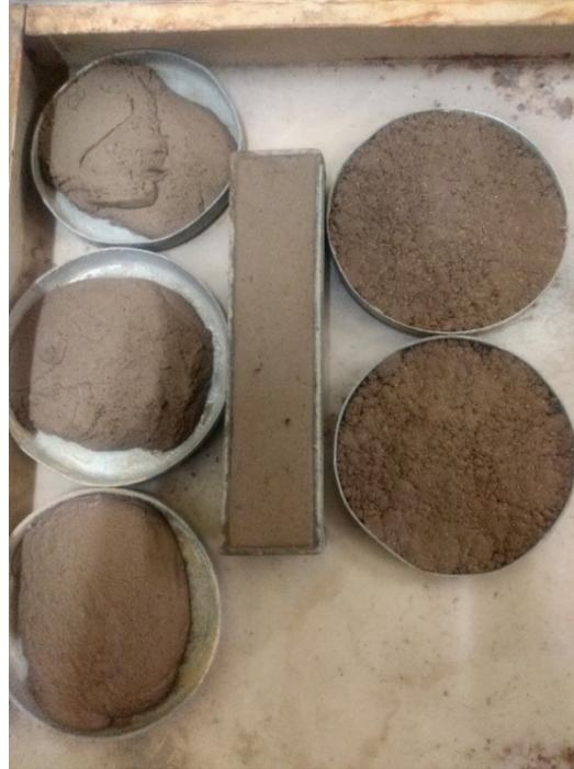
*Figura 27 Muestras de limite líquido, limite plástico y barra de contracción B5 Cerritos*
