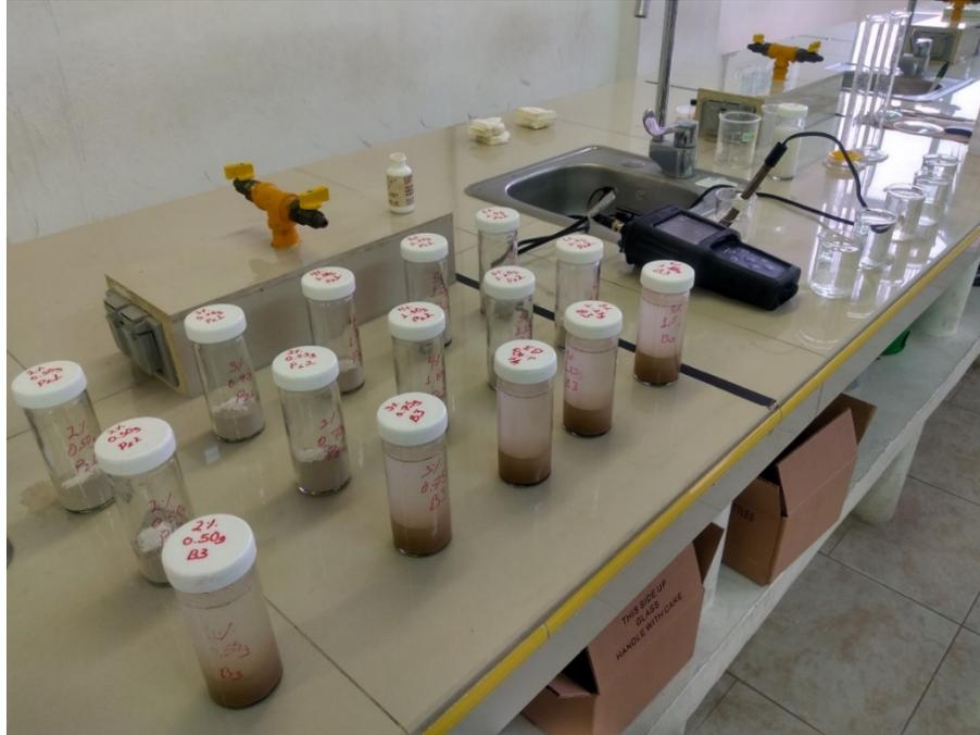
*Figura 29 Botellas con solución para la medición y monitoreo de pH y CE*
