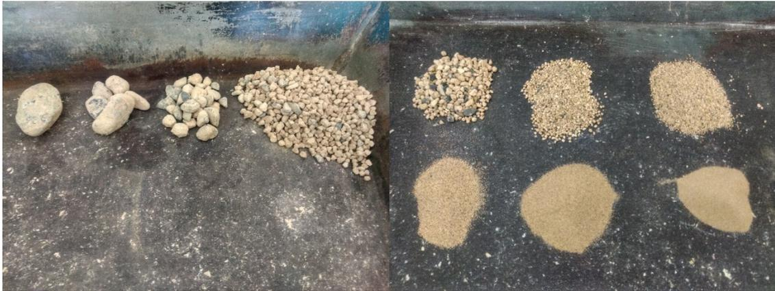
*Figura 18 Granulometría parte gruesa (Izq.) y parte fina (Dcha.) B1 Zayre*
