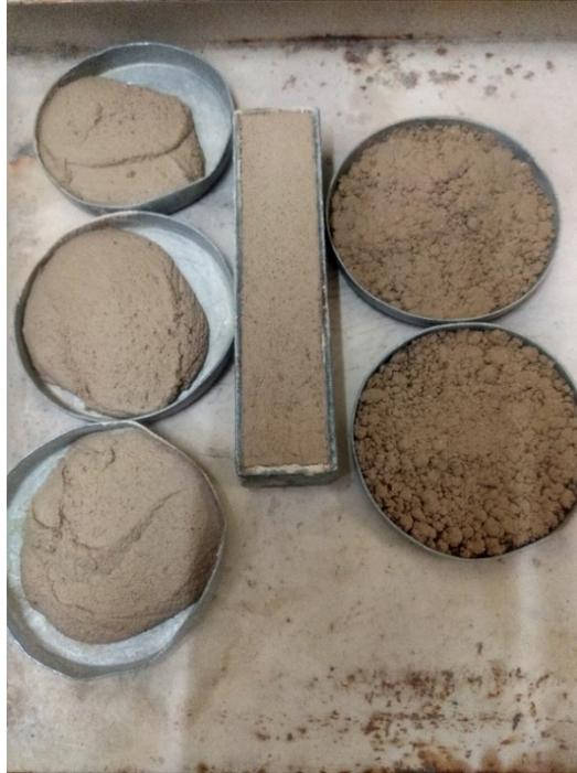
*Figura 25 Muestras de limite líquido, limite plástico y barra de contracción B3 Maqlub*
