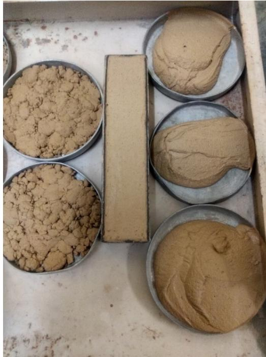
*Figura 23 Muestras de limite líquido, limite plástico y barra de contracción B1 Zayre*
