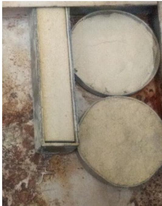
*Figura 24 Muestras de Limite de Consistencia B2 Cumbres*
