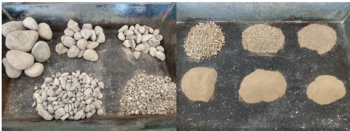
*Figura 20 Granulometría parte gruesa (Izq.) y parte fina (Dcha.) B3 Maqlub*
