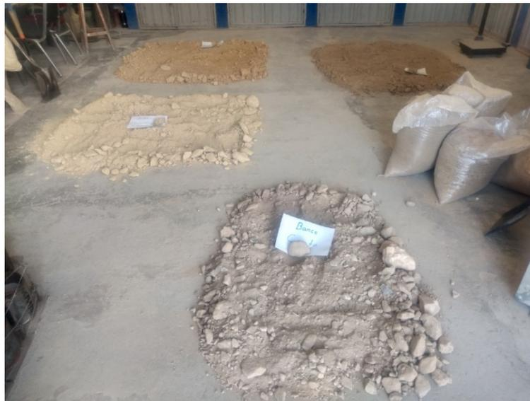
*Figura 16 Preparación de las muestras representativas, tendido, secado y disgregado*
