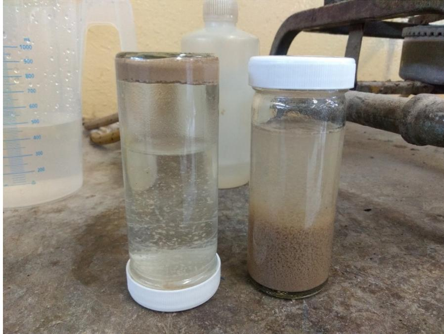
*Figura 31 Botella con soluciones con puzolana (Izq.) y Cal (Dcha.) a un día de reacción*
