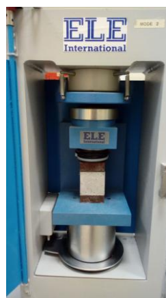
Figura 14. Ensayo de resistencia a la compresión.
