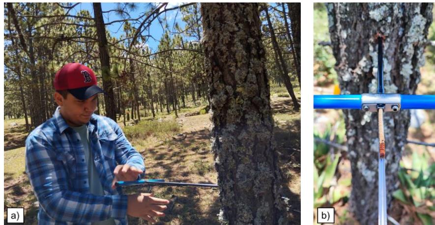
Figura 7. a) Perforación de arbolado con Taladro de Pressler, b) Extracción de núcleo de crecimiento.
