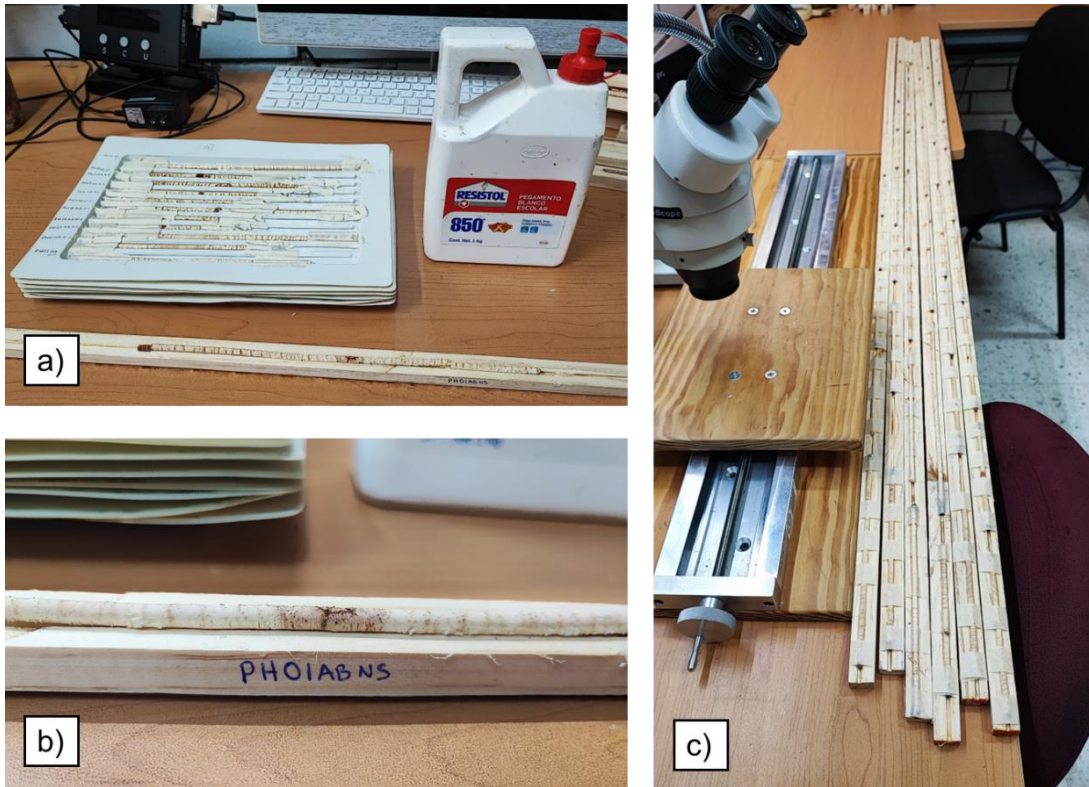
Figura 10. Procedimiento estandarizado para el a) Montaje y pegado del núcleo de crecimiento, b) Identificación de muestra, c) Cinta de papel para ajustar las muestras.
