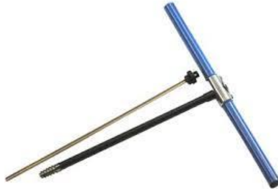
Figura 4. Taladro de Pressler tipo Haglöf.
