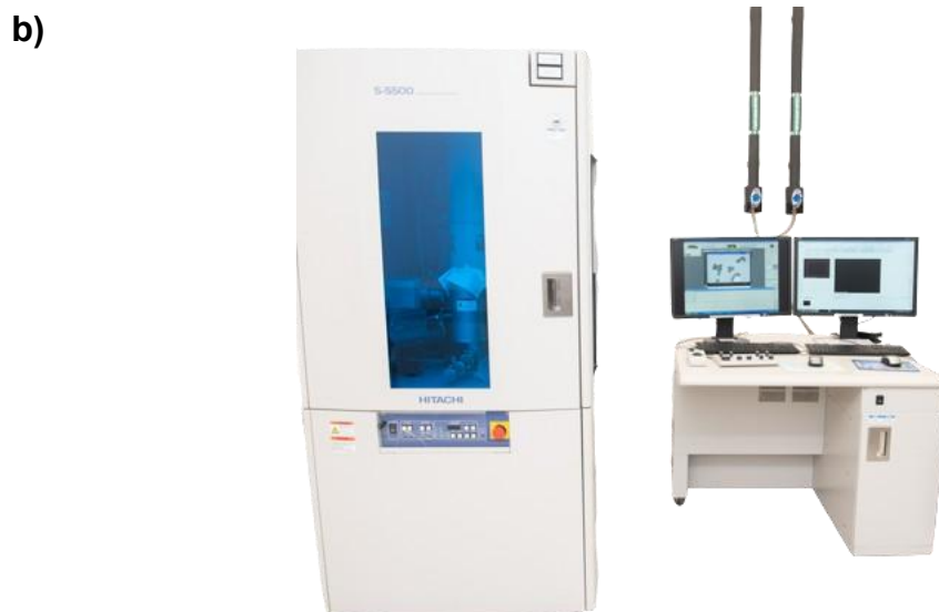
Figura 3.6. a) Esquema del microscopio electrónico de barrido (SEM) [48]. b) Microscopio Hitachi S-5500 FE-SEM.
