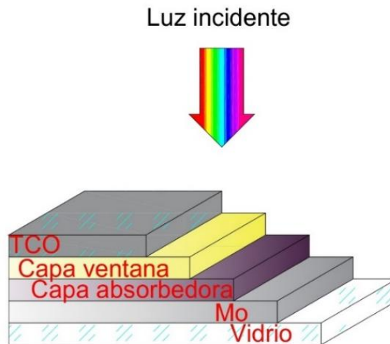
Figura 1.10. Configuración sustrato de una celda solar [21].
