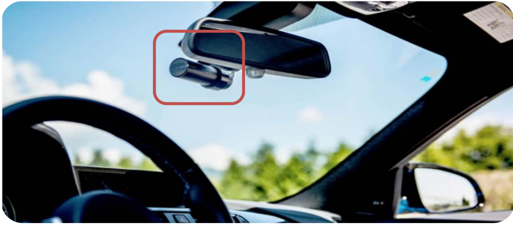
Ilustración 31. Configuración de la cámara frontal centrada en el parabrisas frontal. Fuente: KIA. (2018). Sorento Showroom.
