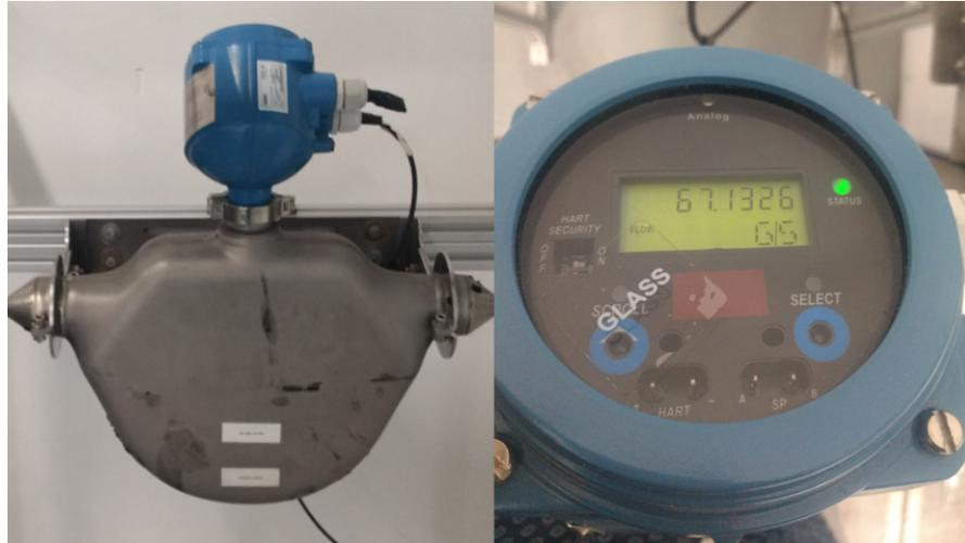
FIGURA 4.11: Medidor de flujo másico.
