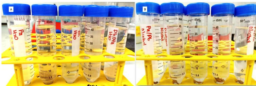
**Figure 45.** Solubilidad de las películas de EPS en agua y etanol absoluto: A) Películas en agua y B) Películas en etanol.
