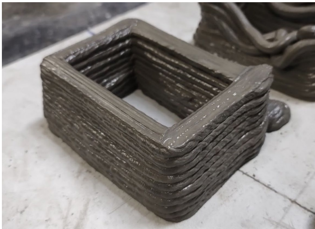
Fig. 26 Elemento impreso con grosor de capa de 5 mm
