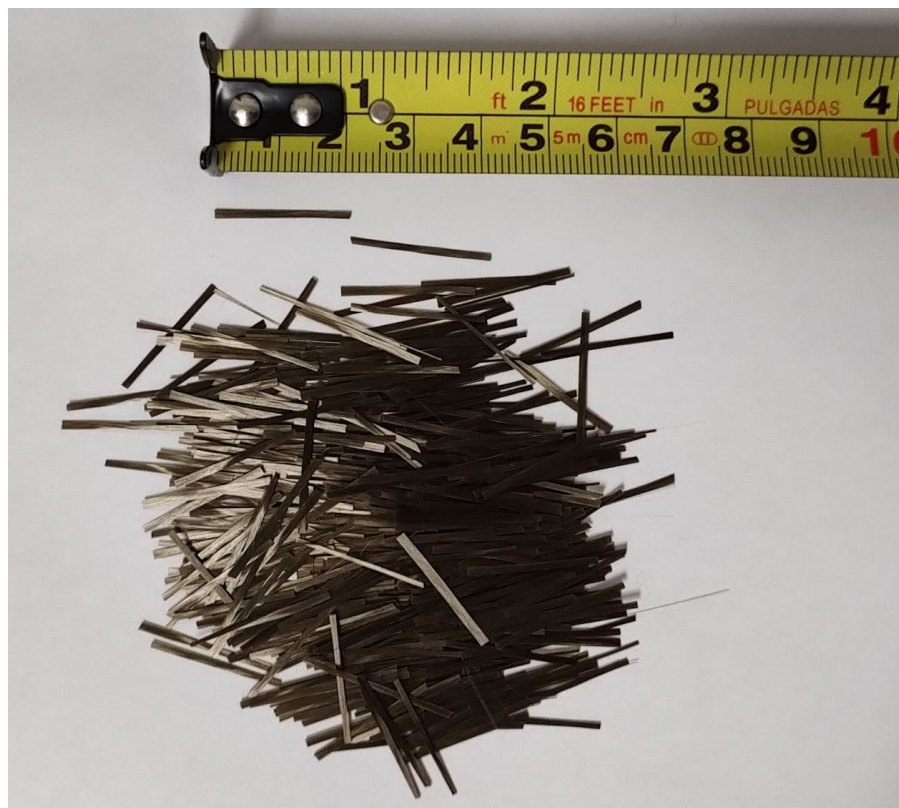
Figura 9. Fibras de basalto aglomeradas de fábrica (sin dispersión).
