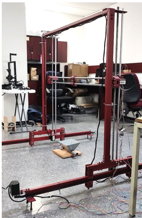
Fig. 24 Impresora 3D de 1x1x1 m 3 construida en el laboratorio
