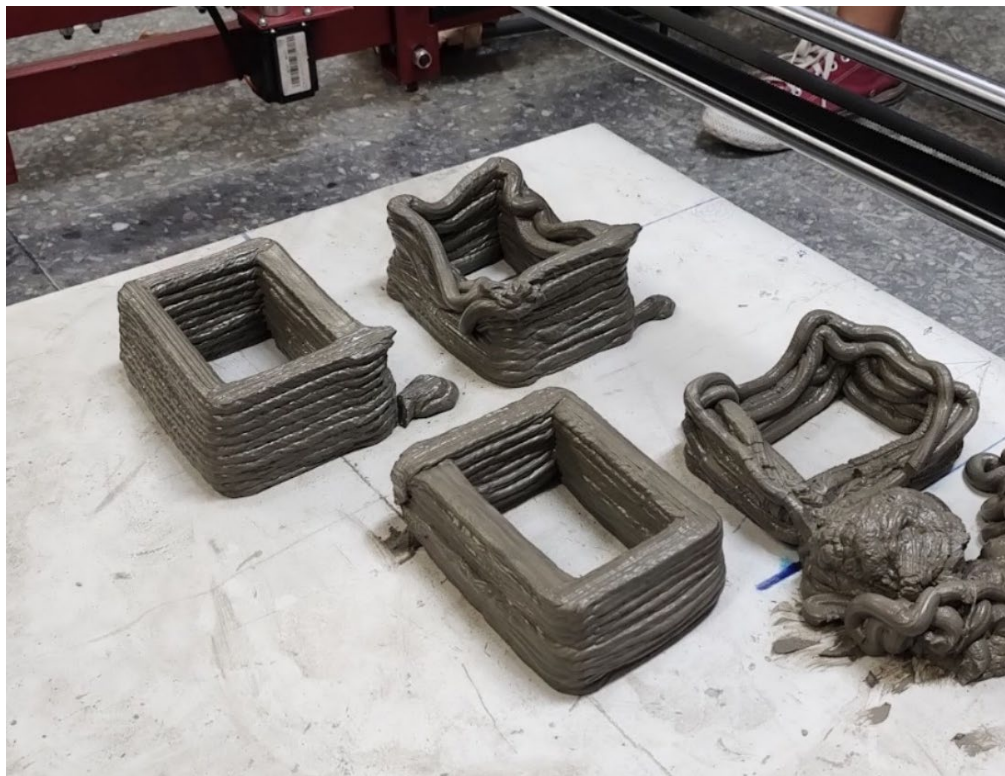
Fig. 25 Elementos de Impresión 3D a diferentes grosores de capa
