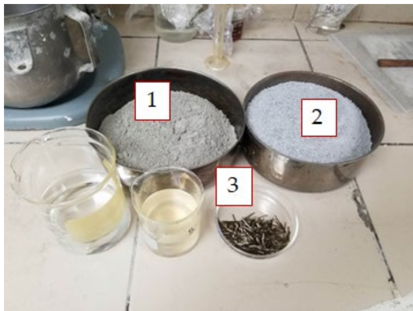
Figura 8. Materiales. (1) cemento portland. (2) Agregado fino. (3) Fibras de basalto.
