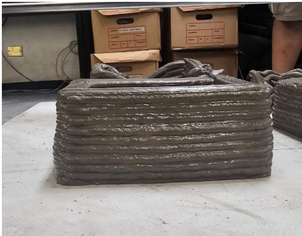
Fig. 27 Estabilidad de capas (Edificabilidad)
