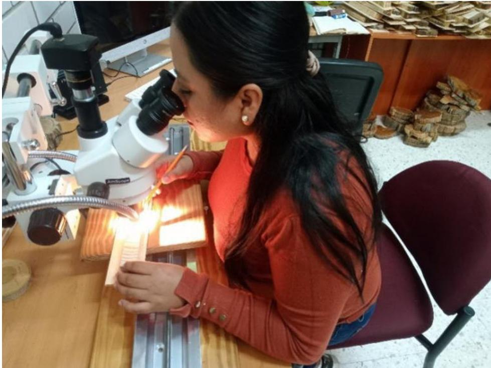
**Foto. 9.** Fechado de muestras con el estereomicroscopio (AmScope™ SM-4TPZ-B) en el Laboratorio de Dendrocronología de la FCF.
