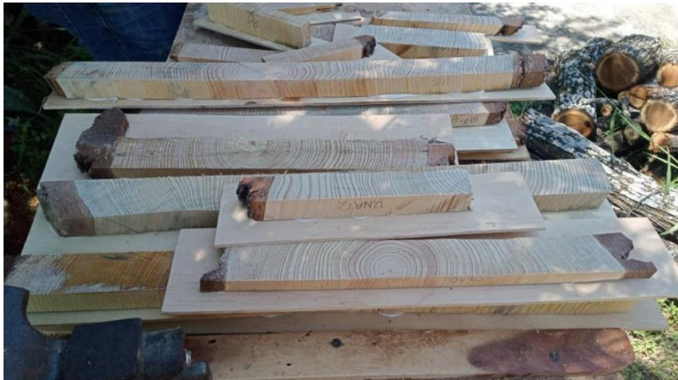
**Foto. 7.** Muestras de secciones transversales dimensionadas y montadas en triplay con pegamento para permitir el pulido.
