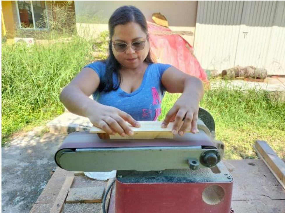
**Foto. 8.** Pulido de las secciones transversales con diferentes lijas hasta lograr una clara diferenciación de los anillos de crecimiento.
