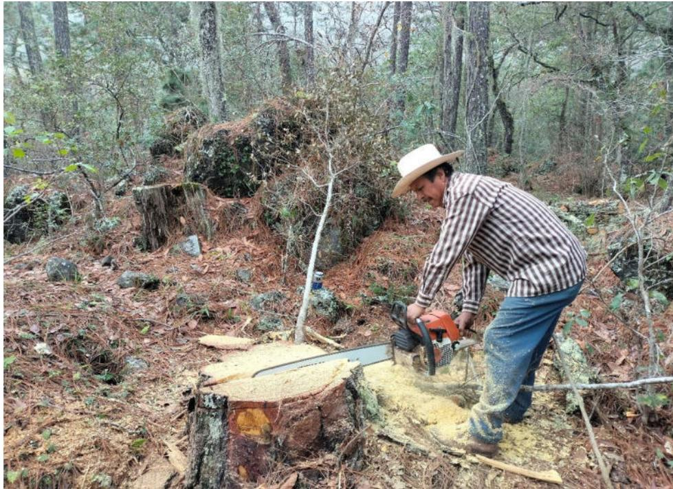
**Foto. 5.** Corta de segmentos de rodajas de 2-4 cm de grosor con motosierra a 0.30 m desde el nivel del suelo como muestras para el análisis dendrocronológico.
