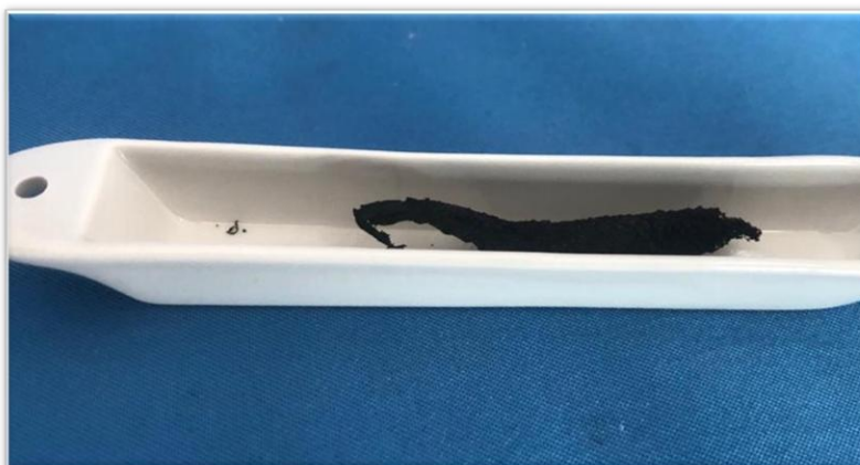
Figura 17 Muestra de nanocarbón derivado de la nanocelulosa después del proceso de pirólisis.
