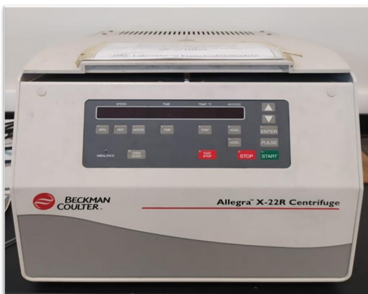
Figura 9 Centrifuga Allegra X-22R marca BECKMAN COULTER utilizada para el lavado de la celulosa.
