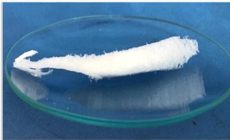
Figura 11 Muestra de nanocelulosa secada por el proceso de liofilizado.
