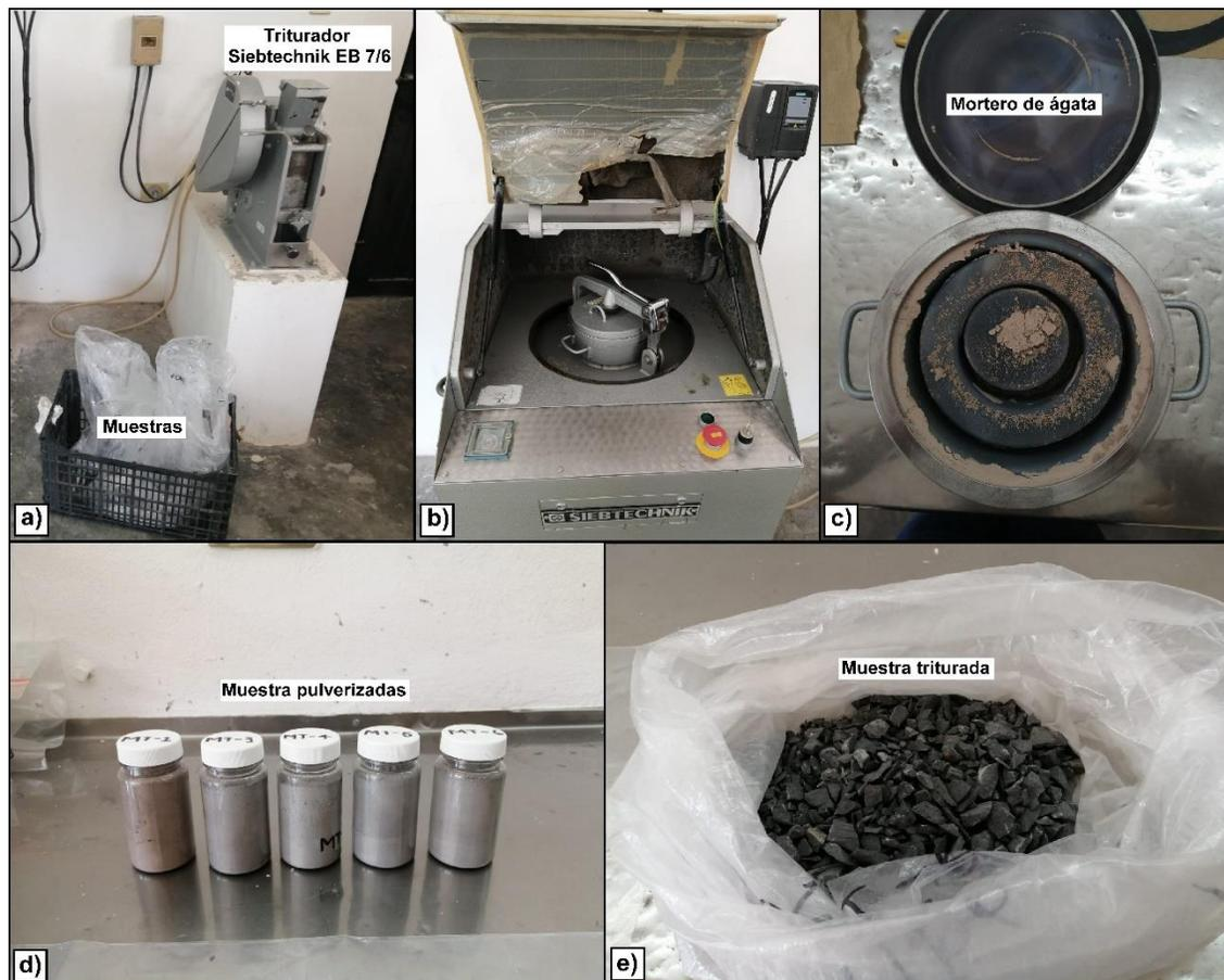
**Figura 1** Instrumentos utilizados durante la trituración y molienda de muestras en el laboratorio de la Facultad de Ciencias de la Tierra; a) triturador *SIEBTECHNIK EB 7/6* de quijadas utilizados para la reducción de fragmentos de roca; b) Molino vibratorio electrónico de ágata; c) mortero de ágata con muestra pulverizada; d) muestra pulverizada y cuarteada; e) muestra triturada a un tamaño de gran aproximadamente  $\sim 1$  a  $3 \text{ cm}^2$
