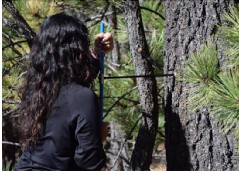
*Figura 5 Toma de muestra de una viruta para el análisis del incremento troncal con un taladro de Pressler ( $\varnothing = 5 \text{ mm}$ ) a 1.3 m del suelo.*
