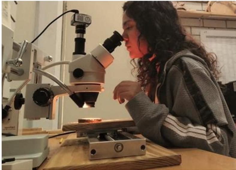
*Figura 7 Medición de los anillos de crecimiento con estetoscopio empleando el sistema Velmex (Bunn, 2010; VoorTech Consulting, 2021).*
