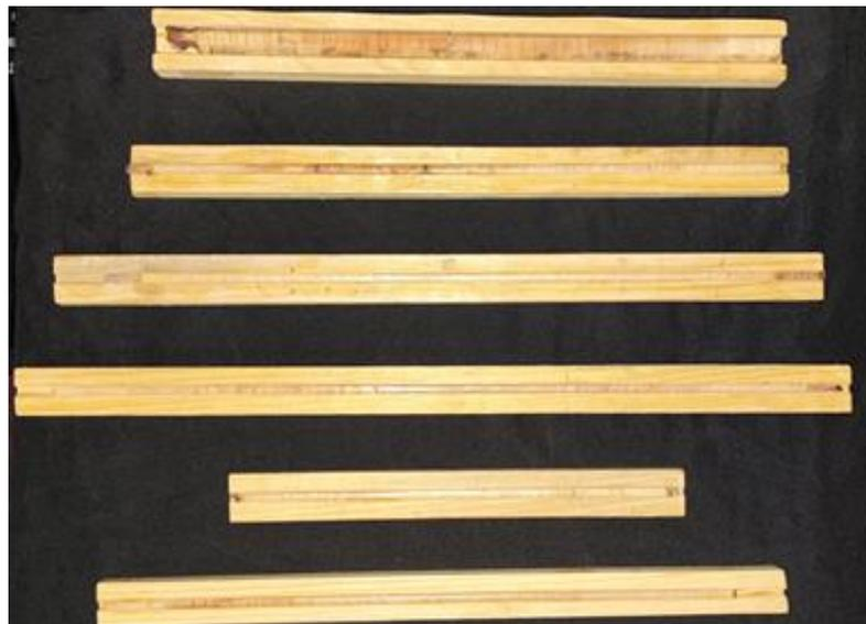
*Figura 6 Virutas secas, montadas en guías y procesadas para su medición.*
