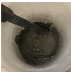
Figura 27. Prueba de trabajabilidad y fluidez de los sistemas preliminares.
