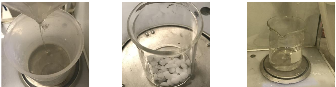
Figura 16. Proceso de obtención de la solución alcalina según los porcentajes de \text{Na}_2\text{O} utilizado.
