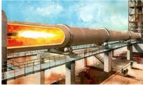
Figura 4. Horno rotatorio usado para la fabricación de Clínter de cemento portland.
