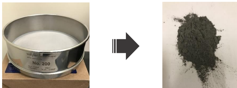
Figura 13. Procesamiento de la ceniza volante utilizada (CV).
