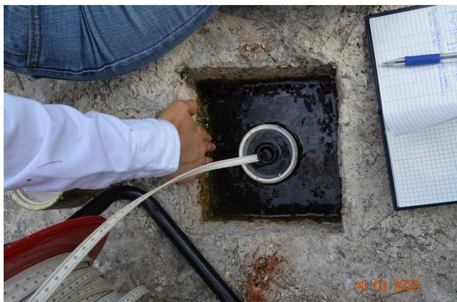
Figura 87. PZ – 3 completamente inundado en el mes de marzo 2023 con 13 % de volumen de llenado de la presa.
