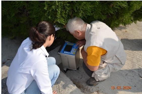
Figura 56. Estación base FCT, toma de medición 60 segundos.
