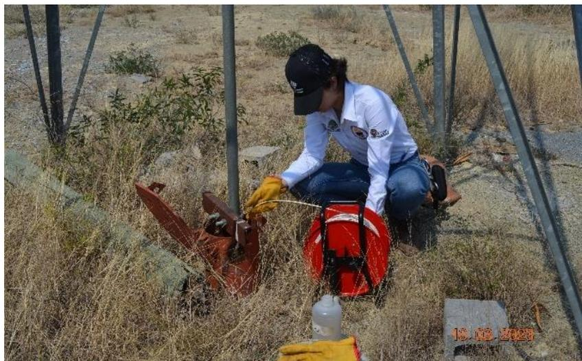
Figura 47. Ejemplo de medición de aprovechamientos hidráulicos en Cerro Prieto, empleando la sonda Solinist.
