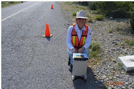
Figura 57. Ejemplo de estaciones realizadas en la cortina, tiempo de toma 30 segundos.
