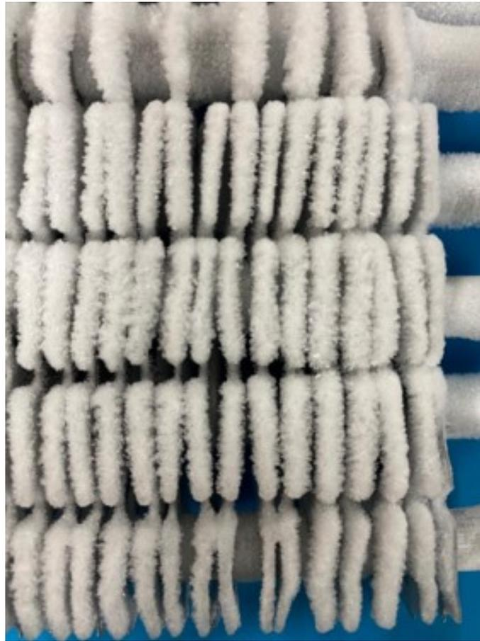
Figura 5.8: Detalle de escarcha formada en intercambiador RC-1. Fotografía tomada a la hora 5 con 40 minutos.
