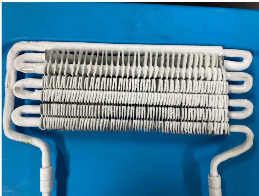
Figura 5.7: Pesaje de intercambiador RC-1 posterior a prueba.
