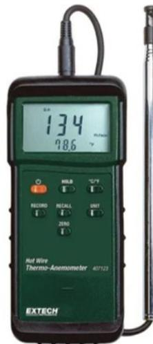
Figura 4.18: Anemómetro EXTECH de Hilo Caliente
