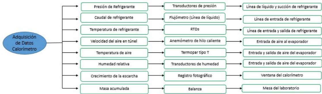
Figura 4.25: Adquisición de datos en calorímetro tipo túnel de viento.
