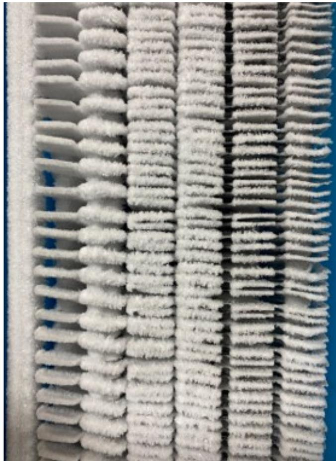
Figura 5.30: Detalle de escarcha formada en intercambiador RC-3. Fotografía tomada a la hora 6 de la prueba.
