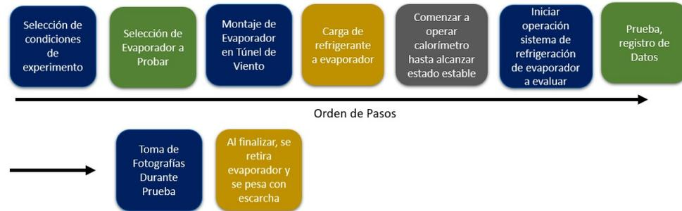
Figura 4.4: Pasos para prueba de evaporador.
