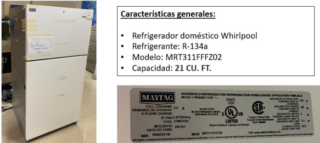
Figura 4.14: Refrigerador doméstico Whirlpool modelo MRT311FFFZ02.
