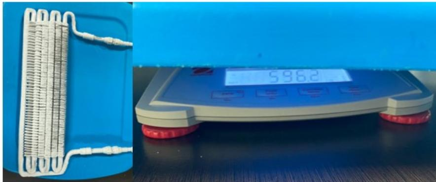
Figura 5.29: Pesaje de intercambiador RC-3 posterior a prueba.
