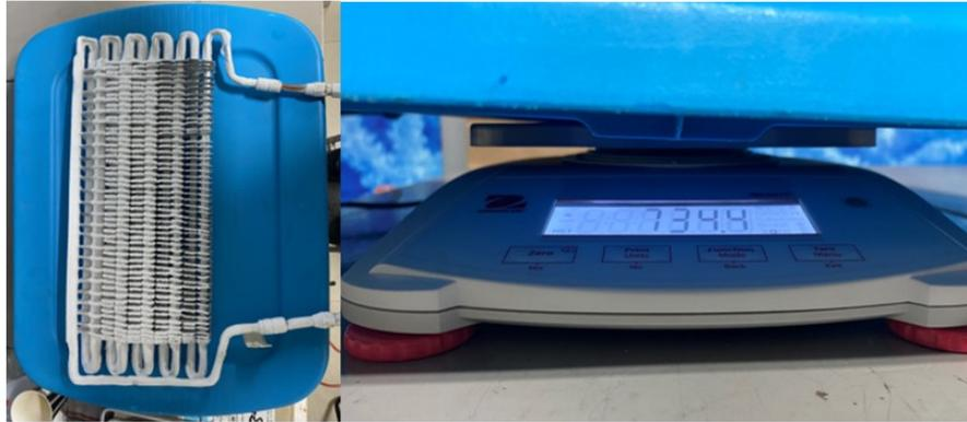
Figura 5.40: Pesaje de intercambiador RC-4 posterior a prueba.
