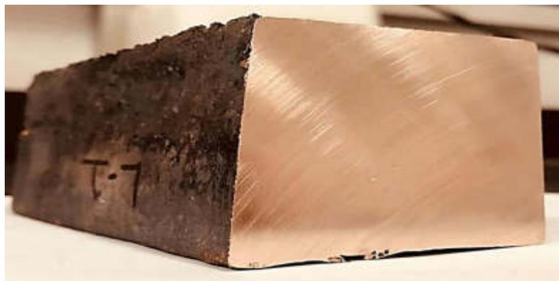
**Figura 3.6.** Lingote rectangular de una aleación de cobre de baja entropía (LEAs).
