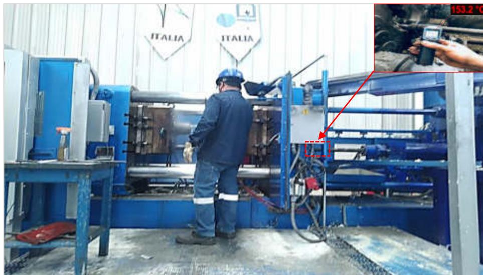
**Figura 2.28.** Máquina de fundición a alta presión en cámara fría.
