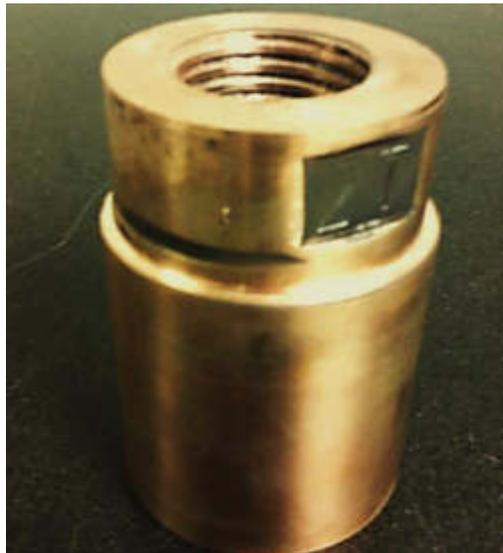
**Figura 1.2.** Émbolo de  $\varnothing 70\text{mm}$  utilizado en HPDC fabricado en la UANL.
