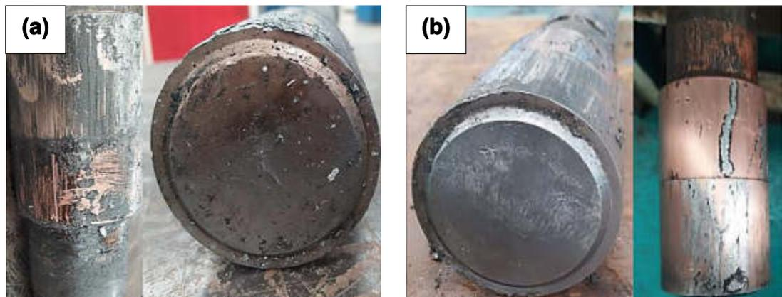
**Figura 2.29.** (a) Punta de  $\varnothing$  70mm desarrollada en la UANL; (b) Punta de  $\varnothing$ 70mm de aleación comercial Cu-Be C17510.
