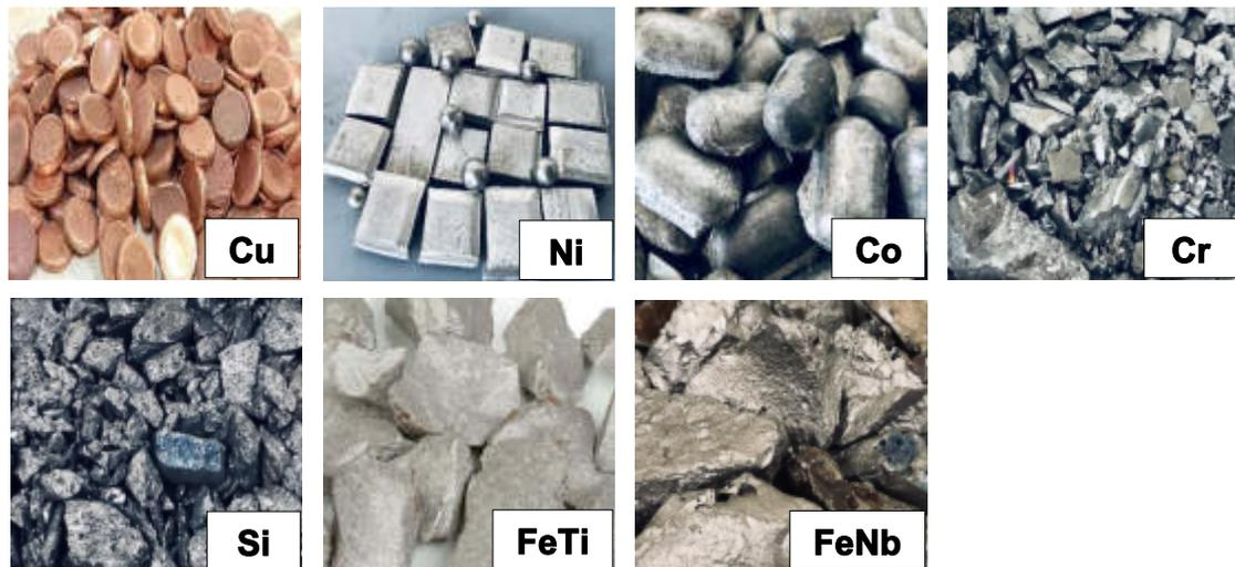
**Figura 3.4.** Elementos constituyentes del sistema de aleaciones (CuNiCoCrSi)Ti<sub>x</sub>Nb<sub>y</sub>.
