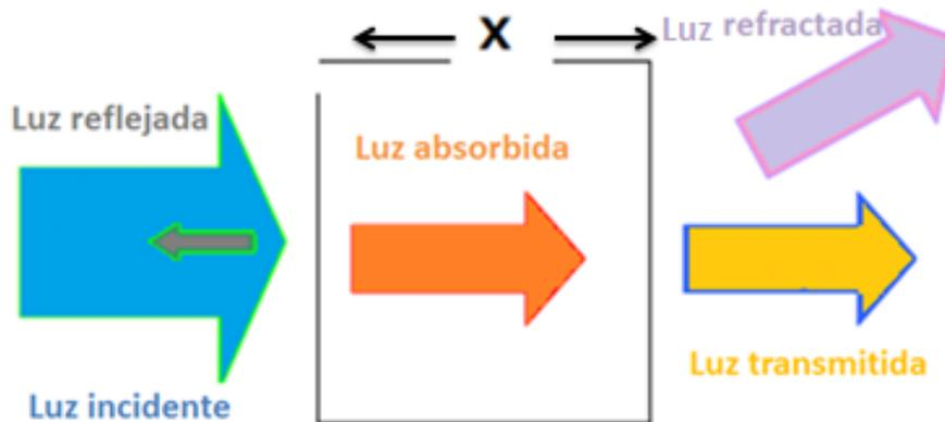
Figura 1.7. Atenuación de la onda electromagnética al pasar a través de un medio absorbente.
