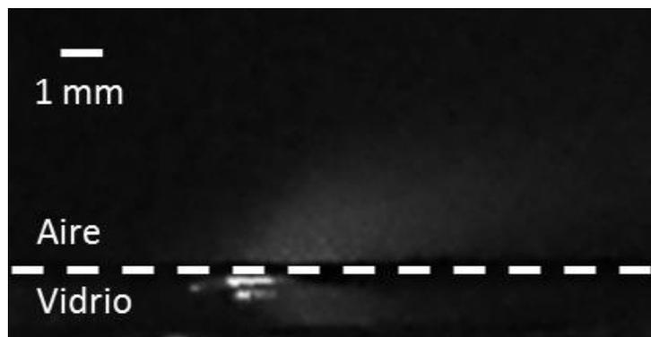
Figura 4.6. Extensión de la luz esparcida debido a la interacción de la onda evanescente con la rugosidad inherente de la superficie.
