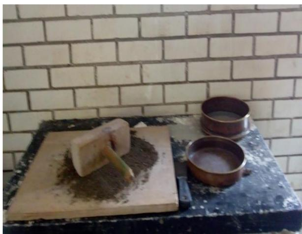
**Figura 26.** Tamizado y equipo utilizado para moler las muestras de suelo analizadas. Marín, N. L.
