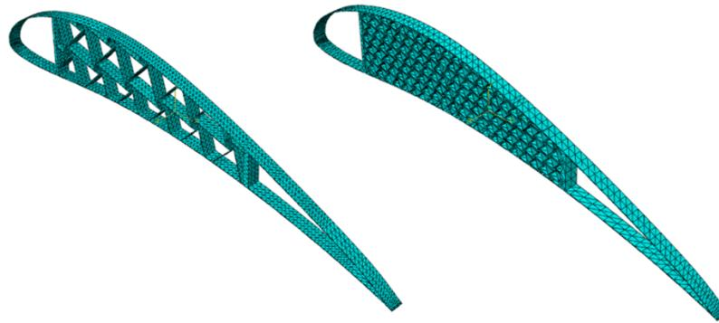
**Figura 3.9.-** Características de mallado de estructuras auxéticas en modelos FEM.
