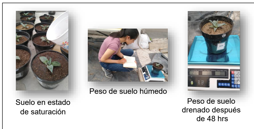
Figura 17. Medición de retención de humedad.
