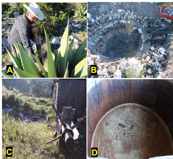
Figura 10. Herramientas para la elaboración del mezcal. Extracción de aguamiel con “acocote” (A); Pozo para cocción de piñas (B); Prensa y molidor para piñas (C); Tambo fermentador de madera (D).
