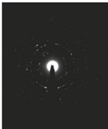
Figura 12: Imagen SAED de patrón de anillos [78].
