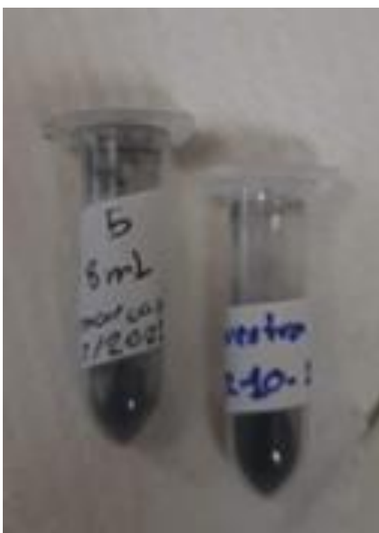
Figura 17: FeS 2 fase pirita obtenida por el método de ultrasonido
