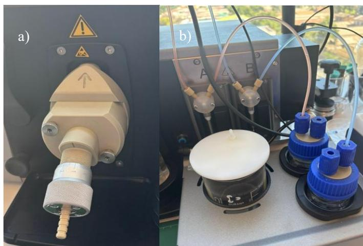
Figura 10. a) Celda cilíndrica donde se coloca la muestra y b) aditamento donde se colocan las soluciones ajustadoras de pH.
