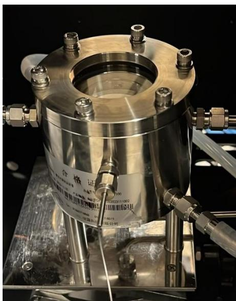
Figura 9. Reactor de flujo continuo CEL-GPRT100.
