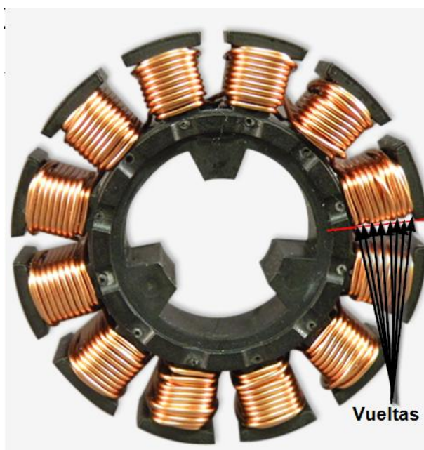
Fig. 27. Bobina, señalando el número de vuelta en cada embobinado. [60]
