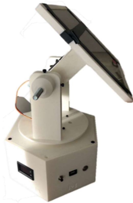
FIGURA 4.9: Prototipo del heliostato ensamblado.
