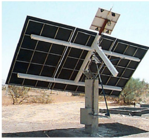
FIGURA 2.2: Heliostato autónomo (Pfahl 2013).
