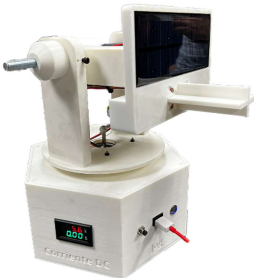
Figura 11: Prototipo de seguidor solar.
