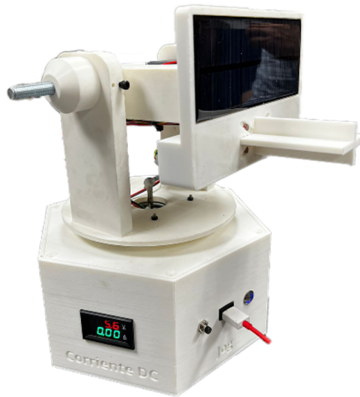
FIGURA 4.10: Seguidor solar primera versión.
