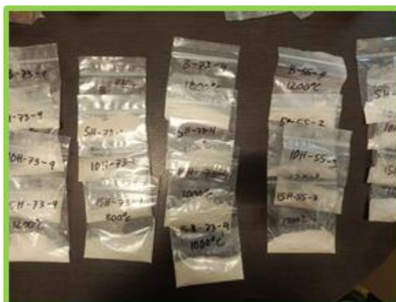
Figura 17. Acondicionamiento de muestras refractarias mezcladas con dross de aluminio para caracterización de DRX.
