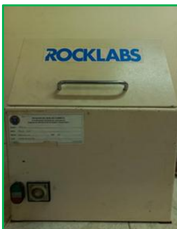
Figura 10. Molino ROCKLABS, utilizado para la molienda de materia prima (base, 5EDH, 10EDH, 15EDH y dross de aluminio).
