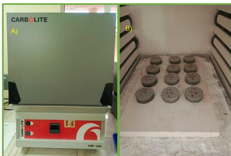
Figura 14. (a) Horno CARBOLITE utilizado para pruebas de corrosión (mezclas refractario – dross de aluminio y pastilla de dross de aluminio), (b) Interior del horno con probetas refractarias con adición de dross de aluminio.
