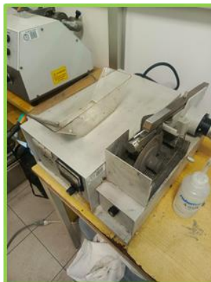
Figura 16. Cortadora de disco de diamante LECO modelo VC- 50, utilizada para cortar las muestras refractarias tangencialmente.
