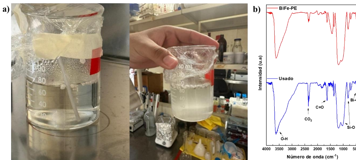
Figura 30. a) Aspecto de la suspensión antes y después del tratamiento con el compuesto, b) espectro FTIR antes del uso y del sólido sedimentado.
