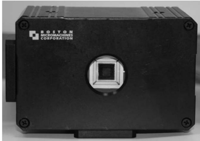
Figura 6.2. Espejo deformable que consta de 140 actuadores electrostáticos.
