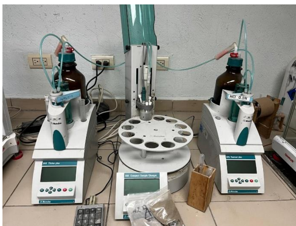
Figura 47. Sistema de titulación para estimación de contenido de cloruros.
