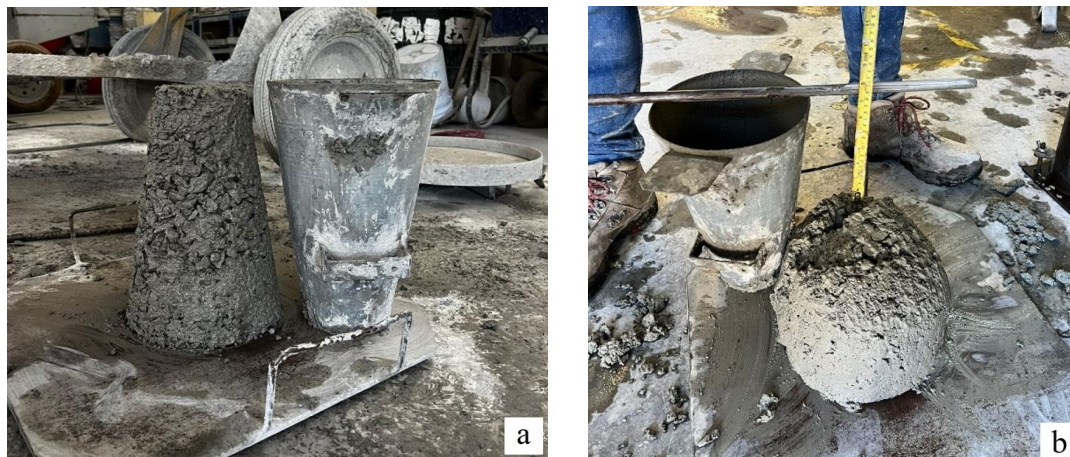
Figura 56. Elaboración de mezclas de prueba. a) Primera bachada con diseño de mezcla inicial. b) Quinta bachada con diseño ajustado y cumplimiento de revenimiento.
