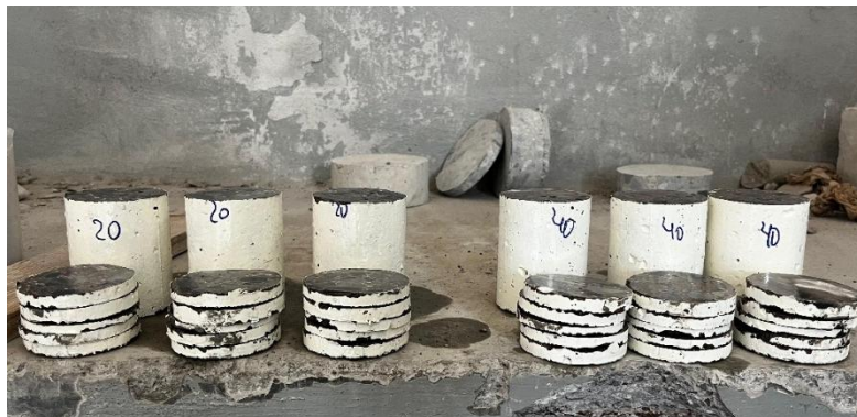
Figura 46. Preparación de muestras para ensayo de coeficiente de difusión de cloruros.
