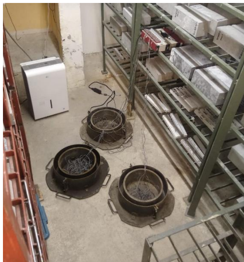
Figura 30. Preparación y fabricación de especímenes para contracción autógena del concreto.
