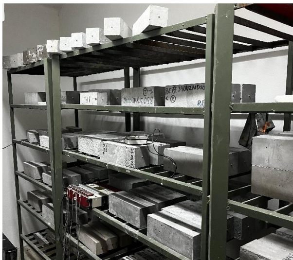
Figura 32. Prismas de concreto en cuarto con temperatura y humedad controlada, fabricados para evaluación de la contracción por secado.
