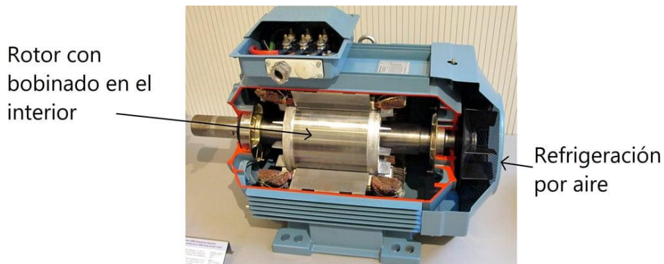
Figura 3.23: Partes motor asíncrono [33]
