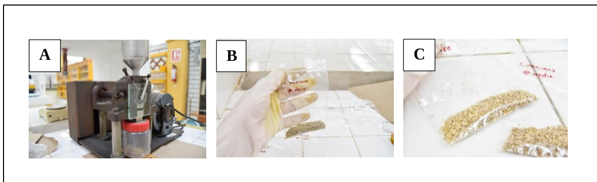
Figura 7. a) Proceso de molido de material; b) Muestra de raíz molida, y c) División por categoría diamétrica.
