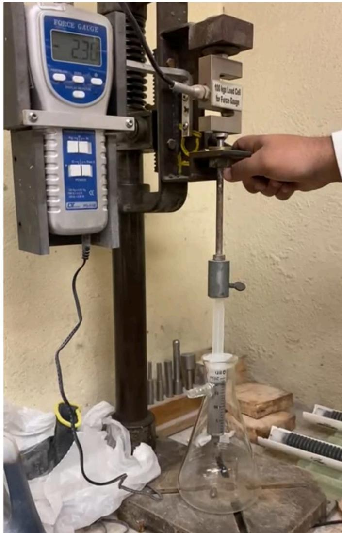
**Figura 21.** Arreglo para determinar la presión de extrusión, utilizando un sensor de carga en un brazo mecánico montado sobre la unidad de impresión
