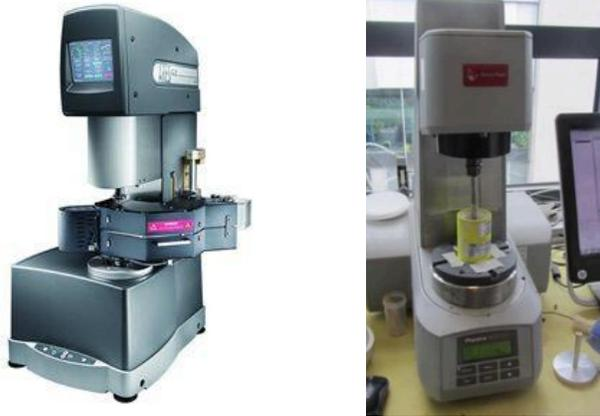
**Figura 16.** Reómetro ARES G2 (Izquierda) [68] y Reómetro MCR 301 (Derecha) [69]
