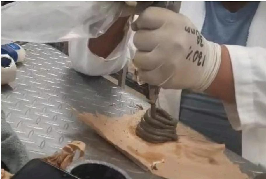
**Figura 32.** Extrusión manual de la mezcla óptima de prueba a través de una unidad con una reducción de área gradual.
