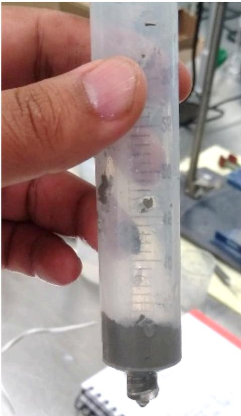
**Figura 30.** Residuo no extruible que queda en la unidad de impresión posterior al taponamiento
