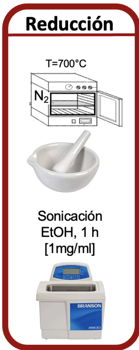
Figura 2.3. Esquema del proceso de reducción térmica para la formación del rGO.
