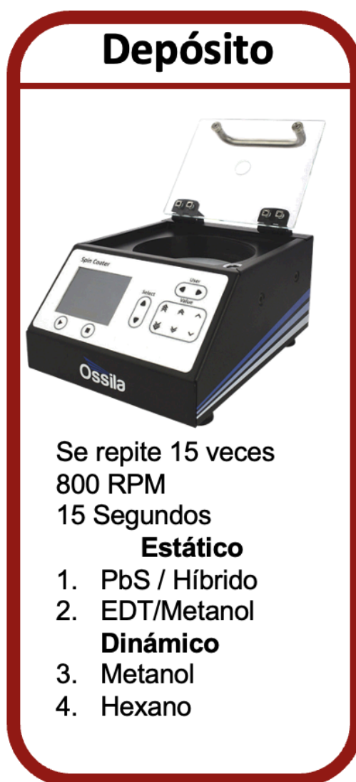
Figura 2.5. Diagrama mostrando la fabricación de las películas delgadas.
