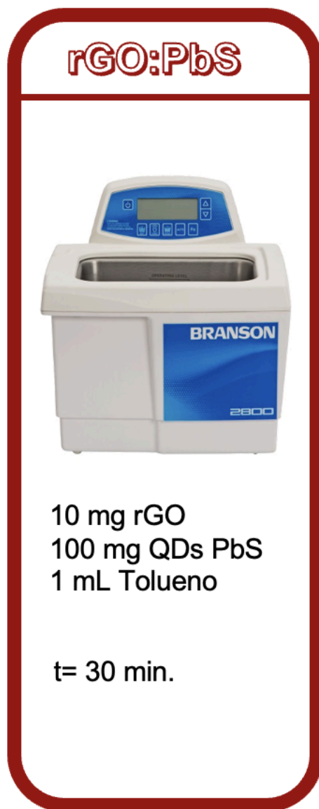
Figura 2.4. Diagrama mostrando la fabricación del Material Híbrido.
