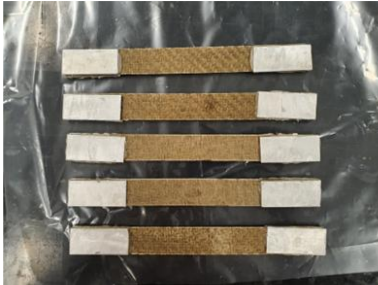
Figura 3.1. Probetas maquinadas para ensayos de tensión en base a norma ASTM D3039.
