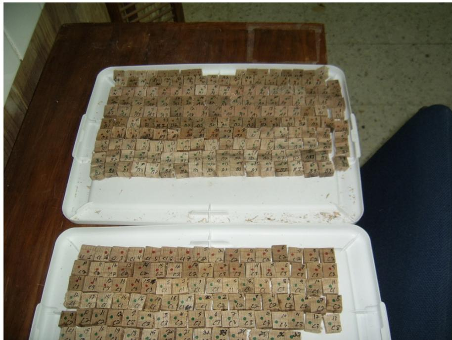
Muestras para módulo de elasticidad y módulo de ruptura
