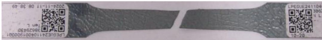
Figura 17. Probeta embozada posterior a ensayo de tensión, comportamiento normal de falla por esfuerzo cortante a 45° observado para todos los materiales ensayados.
