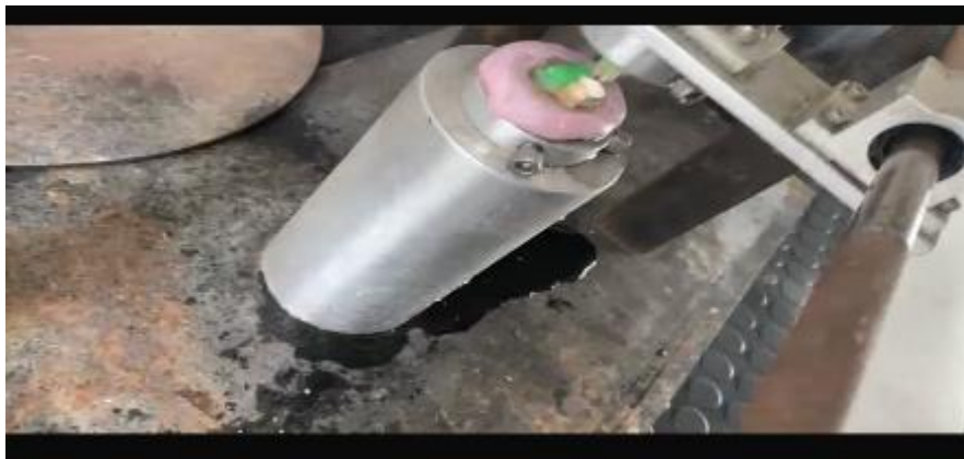
Figura. 8. Muestras colocadas y compuesto acuoso distribuyéndose de manera continua sobre ellas durante el cepillado horizontal
