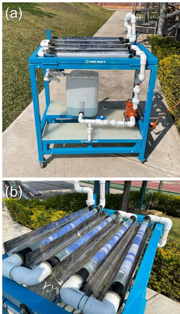
Figura 11. (a) Reactor fotocatalítico con captadores parabólico compuestos (CPC); (b) Filtros monolíticos de sílice dentro del reactor
