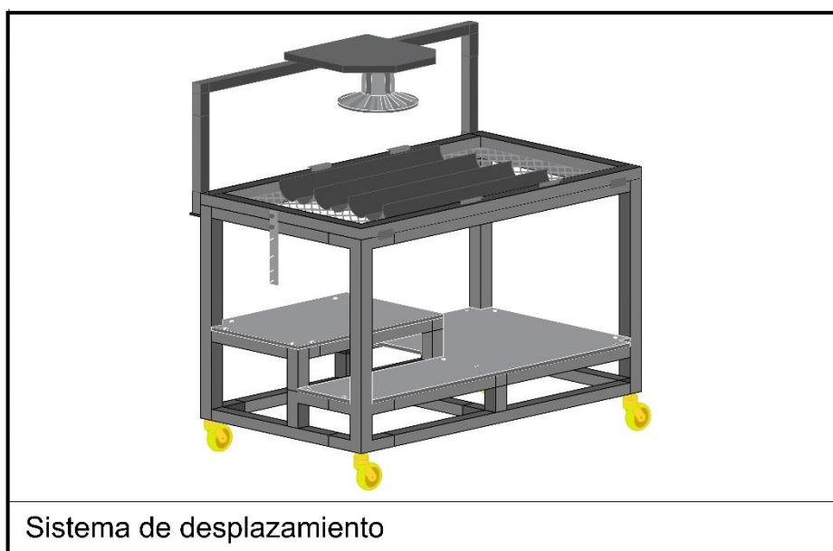
Figura 32. Sistema de desplazamiento del reactor fotocatalítico CPC
