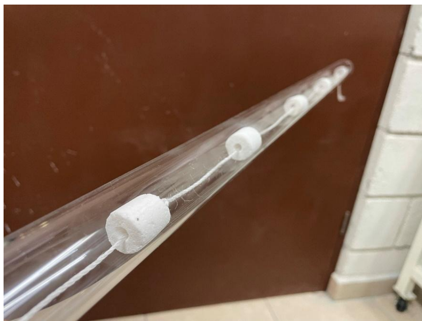
Figura 95. Montaje de los filtros monolíticos dentro del fotorreactor utilizando un hilo de polipropileno
