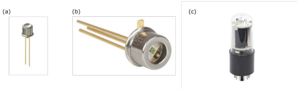
Figura 1.6: Imágenes de los fotodetectores tipo (a) fotodiodos, (b) fotodiodos de avalancha y (c) fotomultiplicadores.
