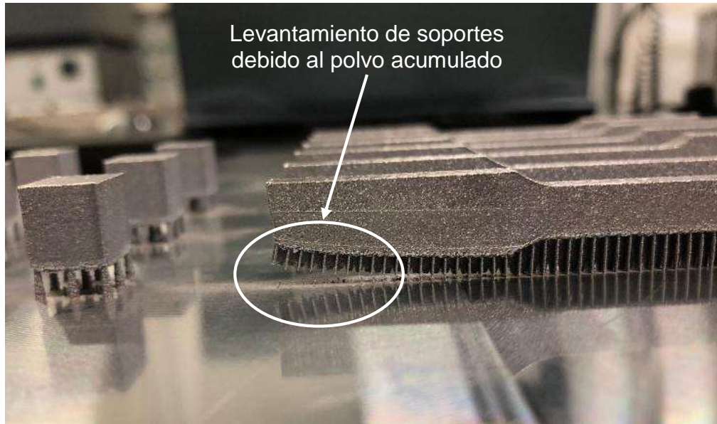
Figura 4.11. Deformación en límite de probetas de tensión de nanocompuesto AlSi10Mg/4.5SiC.
