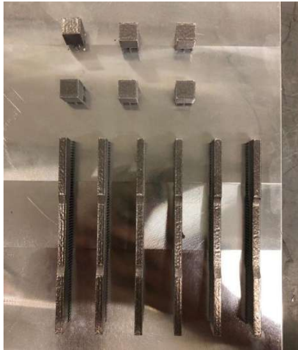
Figura 4.8. Piezas de AlSi10Mg en la placa de impresión recién fabricadas por SLM.
