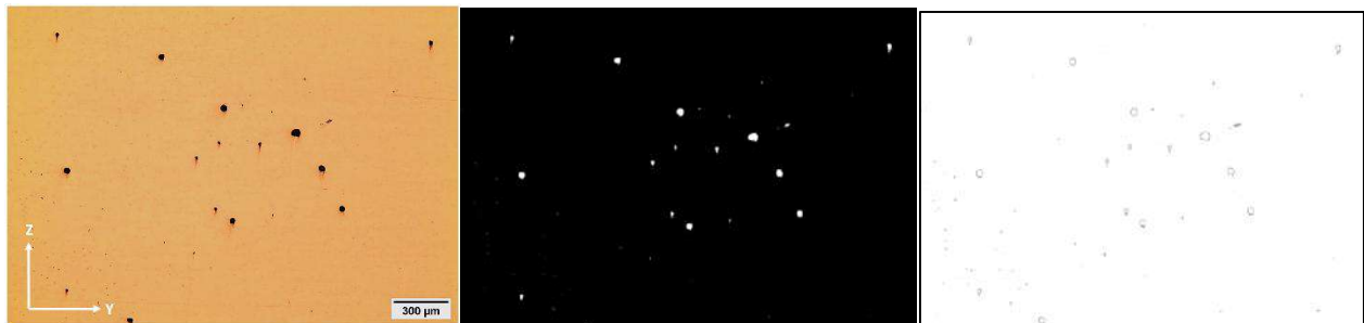
Figura 6.7. Análisis de porosidad en micrografía con orientación ZY de nanocompuesto AlSi10Mg/4.5SiC
