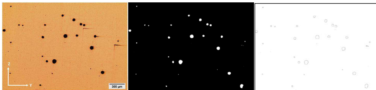
Figura 6.8. Análisis de porosidad en micrografía con orientación ZY de nanocompuesto AlSi10Mg/4.5SiC + SHT a 550°C.
