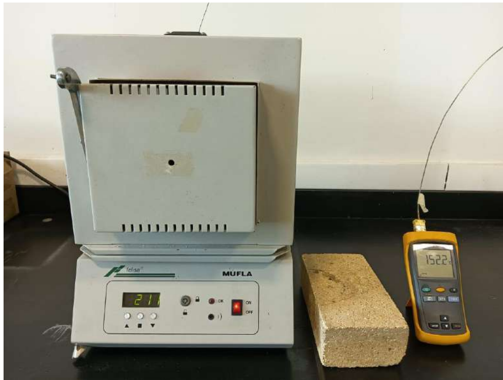
Figura 3.7. Mufla Felisa y termopar Fluke utilizados para el tratamiento térmico T6.
