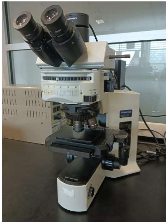
Figura 3.11. Microscopio óptico utilizado para la caracterización superficial.
