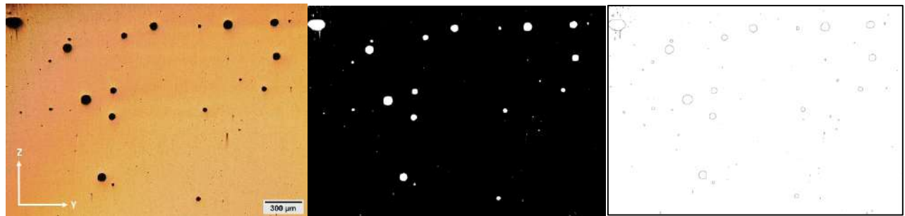
Figura 6.6. Análisis de porosidad en micrografía con orientación ZY de aleación AlSi10Mg con SHT a 550°C + envejecimiento artificial 180°C.
