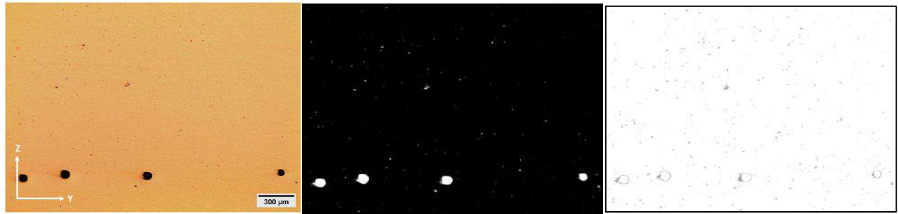
Figura 6.5. Análisis de porosidad en micrografía con orientación ZY de aleación AlSi10Mg con SHT a 550°C.
