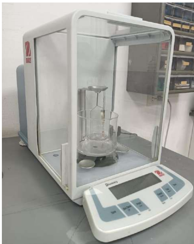
Figura 3.14. Balanza analítica OHAUS Discovery utilizada para Método Arquímedes.
