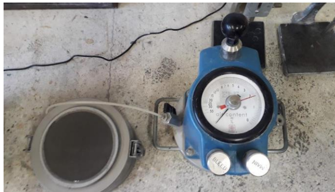
Fig. 16. Equipo para determinar contenido de aire en la mezcla de acuerdo con ASTM C231.
