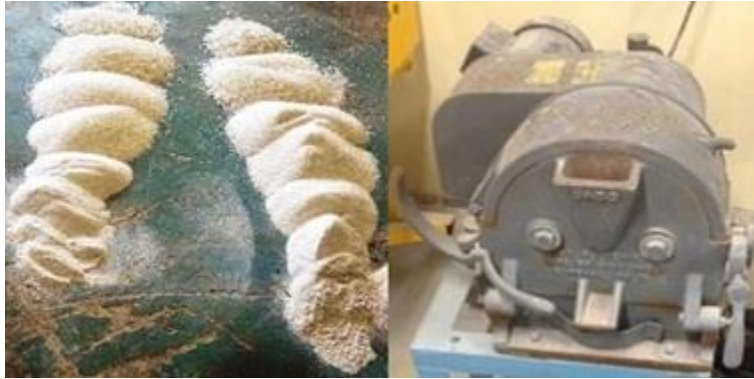
Fig. 10. Pulverizadora y polvo de vidrio de borosilicato posterior a la molienda.
