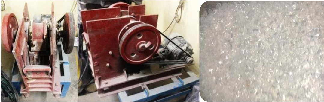
Fig. 8. Trituradora de quijadas y primera molienda de vidrio.
