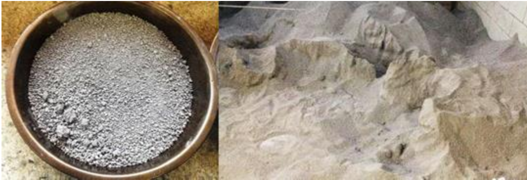
Fig. 5. Agregados finos de caliza utilizados en el proyecto.
