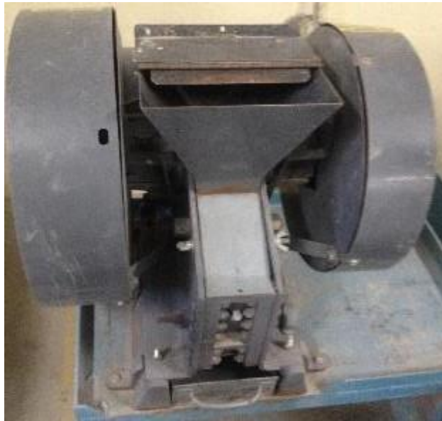
Fig. 9. Trituradora de quijadas para molienda secundaria.
