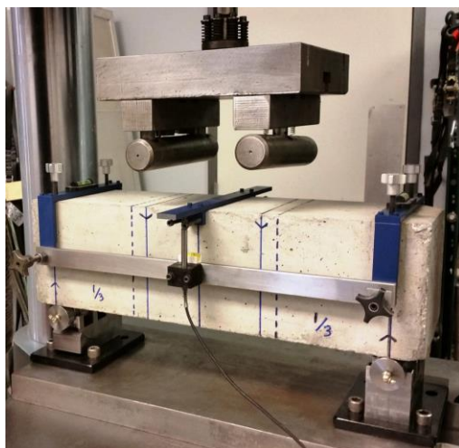
Fig. 19. Viga montada para ensayo a flexión de acuerdo a criterios de ASTM C1609.
