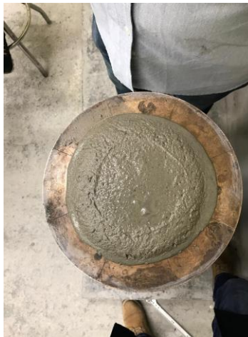
Fig. 17. Mesa de Fluidez, con mezcla de control sin fibras.
