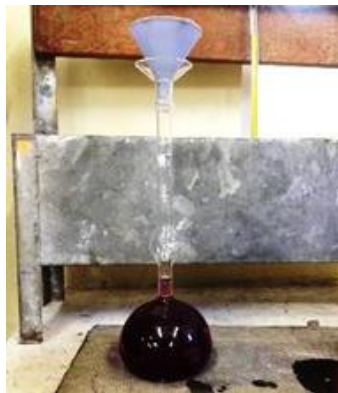
Fig. 2. Picnómetro de volumen conocido.
