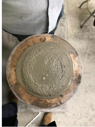
Fig. 21 Mesa de extensibilidad con mezcla de control, al momento de ejecución del ensayo.
