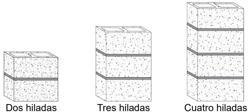
Figura 6. Pilas de bloques huecos de concreto.
