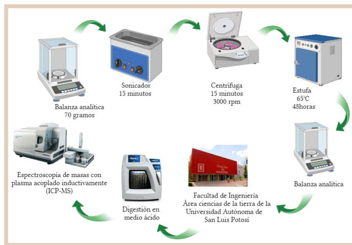
Figura 7. Análisis de muestras con Espectrofotómetro de masas con plasma inductivamente acoplado (ICP-MS).
