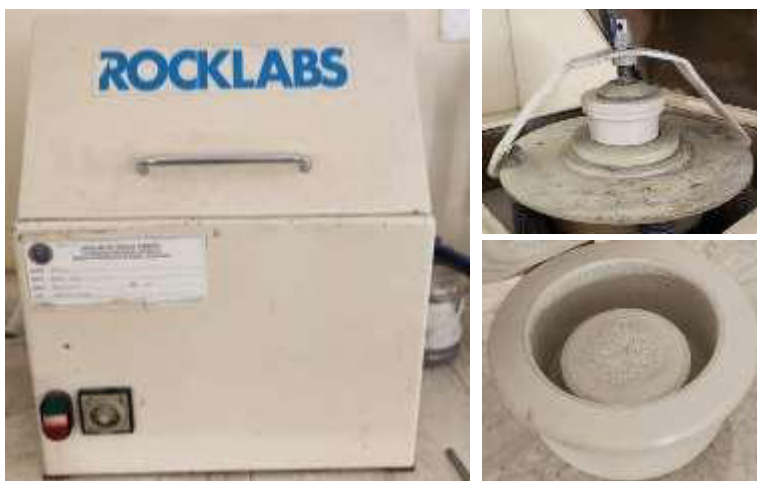
Ilustración 14. Equipo de triturado "Rock lab".
