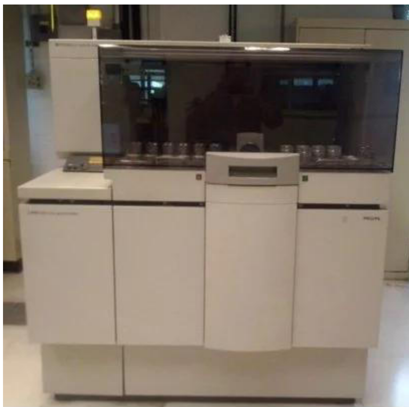
Ilustración 1. Espectrómetro de Fluorescencia de Rayos X-Philips PW 2400
