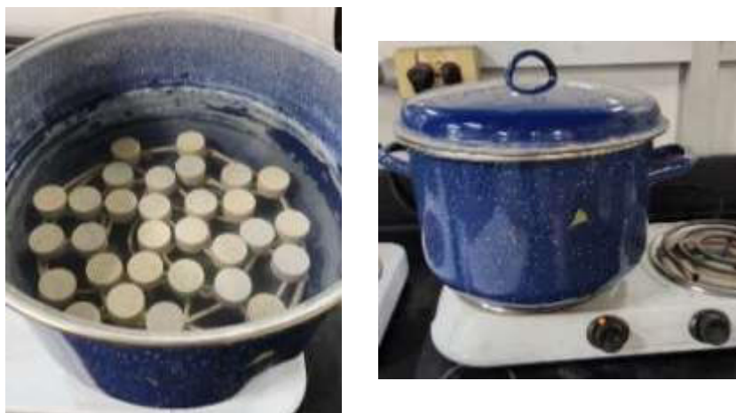
Ilustración 8. Colocación de muestras a saturar.
