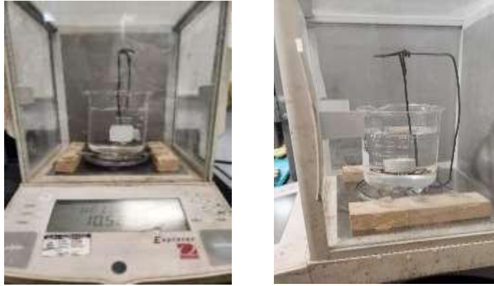
Ilustración 9. Pesaje de probeta suspendida (peso suspendido).
