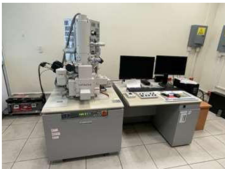
Ilustración 3. Equipo para microscopía electrónica de barrido "HITACHI SU8020"
