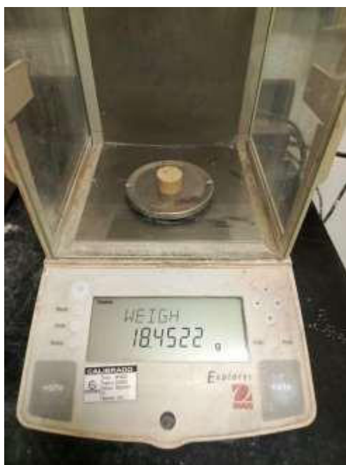
Ilustración 7. Pesado de probetas experimentales en seco (D).
