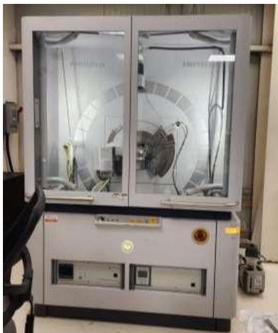
Ilustración 2. Equipo para difracción de rayos X "PANalytical X'Pert 3 Powder"
