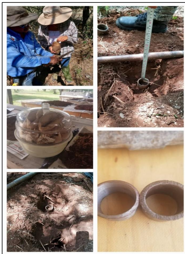
Figura 10. Obtención de la Densidad aparente ( D_a ) en los cuatro tipos de suelos
