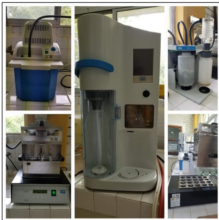
Figura 9. Equipo Velp Scientifica modelo UDK159 para el análisis de Nitrógeno total (%)
