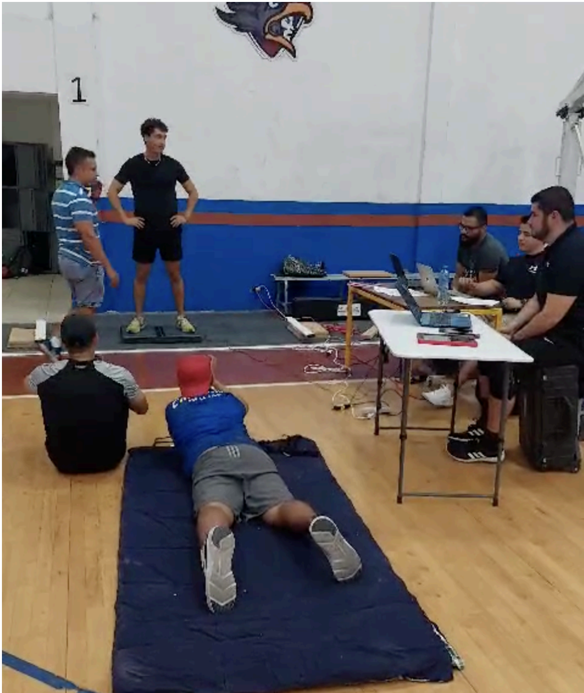
Figura Suplementaria 3. Pruebas piloto de configuración espacial: determinación de la profundidad óptima para posicionar cinco dispositivos móviles simultáneamente, garantizando un campo de visión común y la captura concurrente de la elevación del salto.
