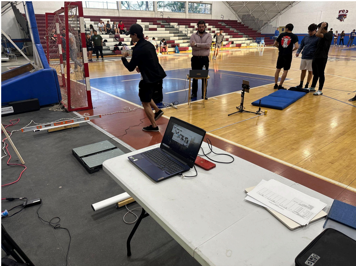
Figura Suplementaria 6. Configuración piloto definitiva para la evaluación concurrente, mostrando la sincronización y calibración conjunta de los cinco sistemas de medición (plataforma de fuerza, análisis manual A/B, IA y sistema infrarrojo) para garantizar la integridad temporal y espacial de los datos.
