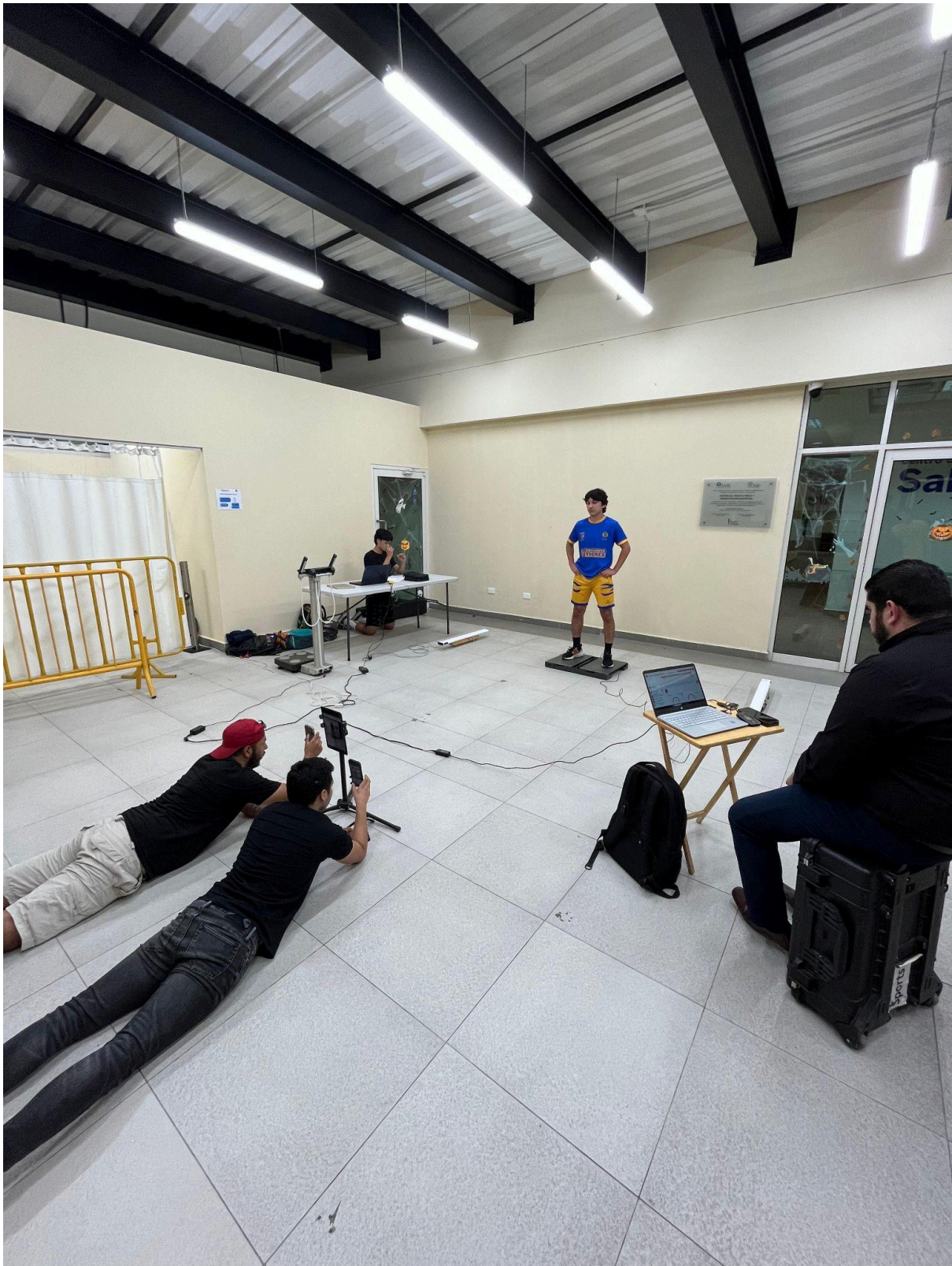
Figura Suplementaria 12. Disposición íntegra del área de prueba en el momento del inicio de los saltos: posición de cámaras, plataformas, sensores infrarrojos y marcadores de referencia, asegurando la sincronización temporal y la visibilidad óptima de cada sistema para la medición simultánea de todos los intentos.
