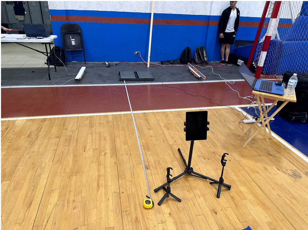
Figura Suplementaria 8. Montaje definitivo para la evaluación concurrente en el experimento pilotaje: disposición sinérgica de la plataforma de fuerza, el sistema infrarrojo y los tres dispositivos de grabación (dos para análisis manual, uno para CV+IA 30 fps / 4K), garantizando la sincronización y homogeneidad en la captura de los tres tipos de salto.
