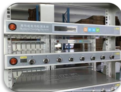
Figura 14. Ciclador de la marca Neware, para pruebas de ciclado profundo y ciclado variable rápido.
