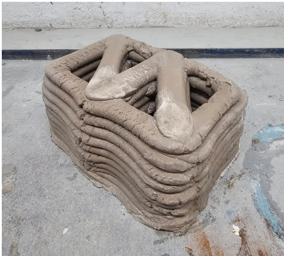
Figura 69. Tabicón impreso en 3D usando la tinta optimizada de TPE/CP para un modelo con patrón de impresión en zigzag.
