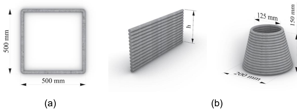
Figura 8. Evaluación para la printabilidad según Bhusal y col. (2023): a) medición de la extrudabilidad; b) mediciones de edificabilidad [87].
