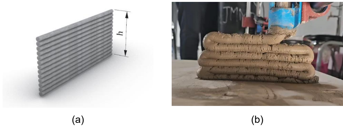
Figura 32. Prueba de edificabilidad: a) esquema de la prueba adaptado de Bhusal y col. (2023) [87] ; b) prueba de edificabilidad en impresora del GIDECON.
