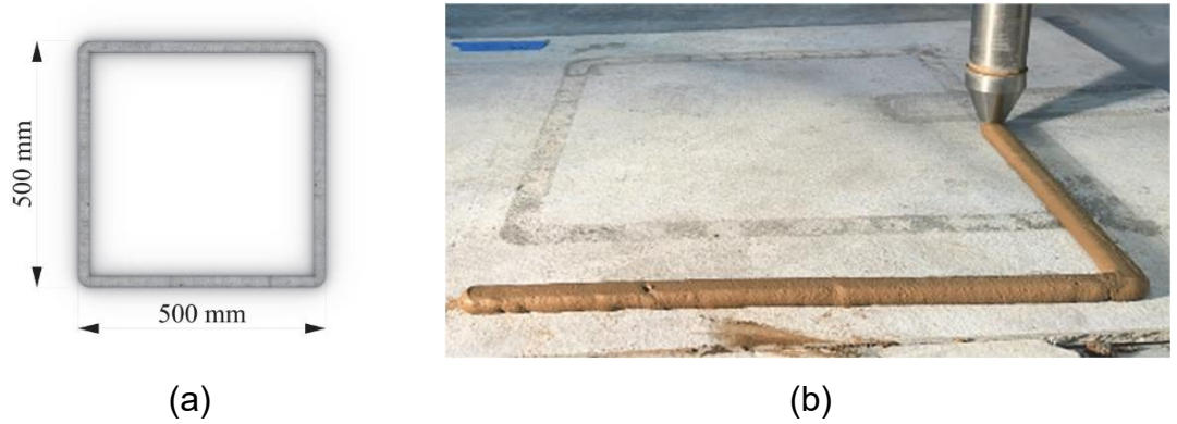
Figura 14. Ensayo de extrudabilidad: a) protocolo de prueba y b) evaluación de la extrudabilidad en impresora 3D de laboratorio [87] .
