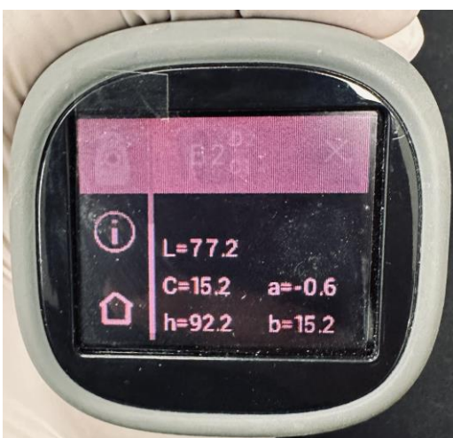
Figura 7. Resultado en la pantalla de EasyShade
