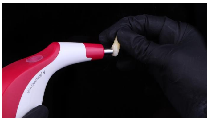
Figura 6. Ejemplo de toma de color con el espectrofotómetro EasyShade
