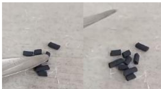
Figura 20 Prueba cualitativa de integridad mecánica, pellets soportan la presión de la espátula sin hacerse polvo
