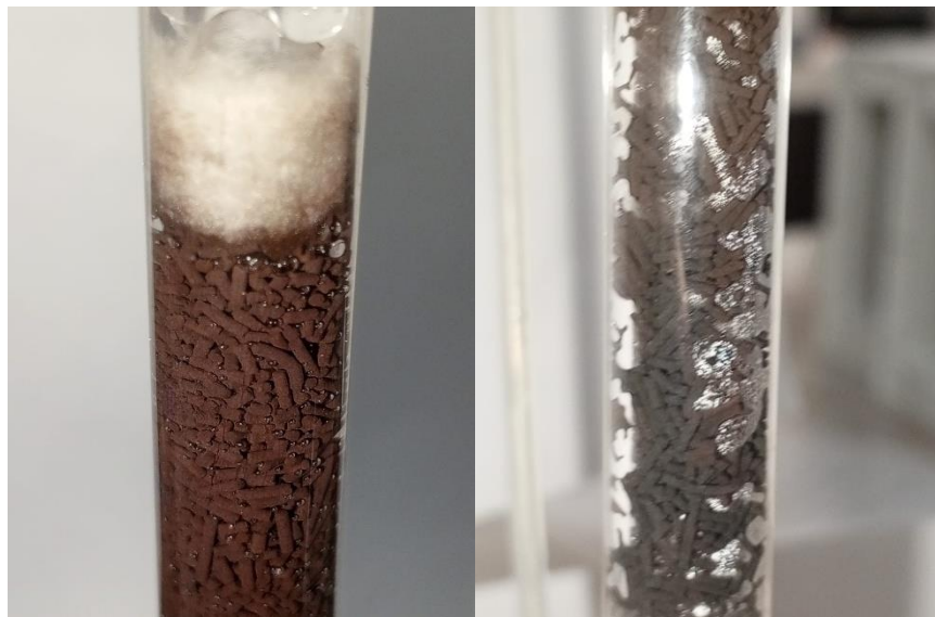
Figura 29 Fotografías de la columna al inicio del proceso de adsorción y después de varias horas de operación, donde se observa la formación progresiva de burbujas que generan parches de aire de mayor cobertura dentro del lecho
