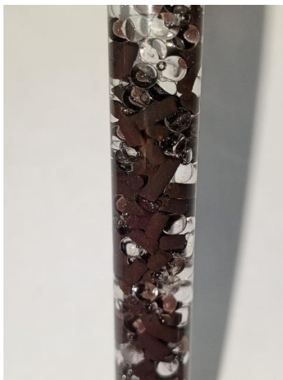
Figura 31 Fotografía del lecho de pellets mezclados con esferas de borosilicato como diluyente
