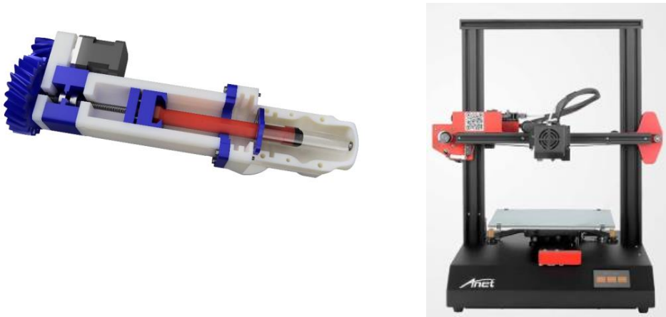
Figura 4 Diseño del pistón e impresora comercial empleada en para la obtención de monolitos
