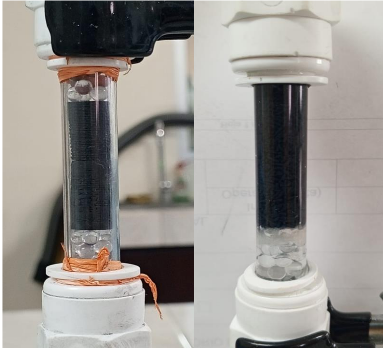
Figura 26 Fotografía de pellets y monolitos empacados en una columna
